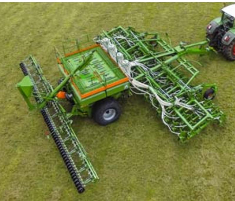
Между тем, мы разработали «DMC 12001» с шириной захвата 12 м – требуемая мощность трактора 400–500 л.с. – и ввели в эксплуатацию в опытном порядке.
