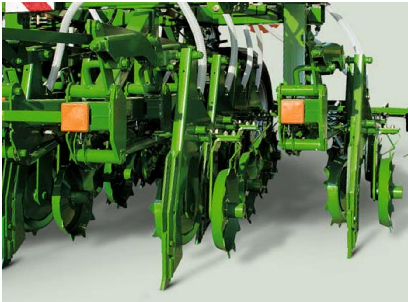
**Расположение сошниковых модулей на продольных траверсах в 4 ряда друг за другом создает большое пространство между ними. Таким образом обеспечивается хорошее прохождение соломы.**
