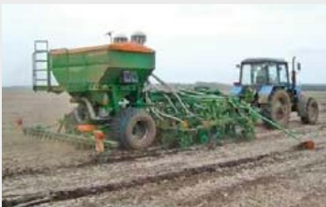
**Рис. 5:** Пробный посев кукурузы сеялкой DMC 4500 с междурядьем 75 см и одновременным внесением удобрений по схеме 5 см от рядка и 5 см глубже (8 мая 2009 г.)
