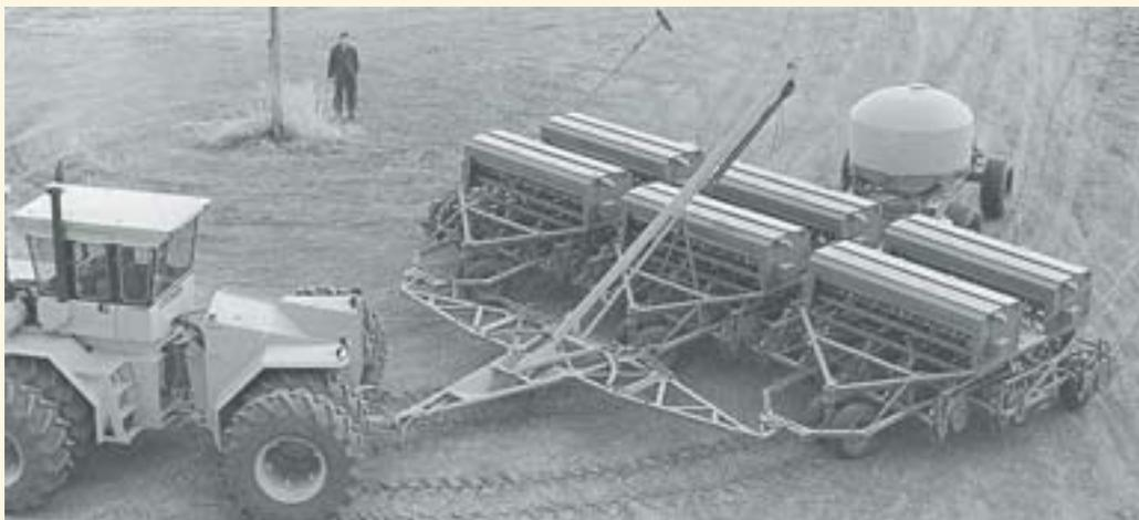
Сеялка для прямого посева AMAZONE NT; ширина захвата 3 x 3,75 м
