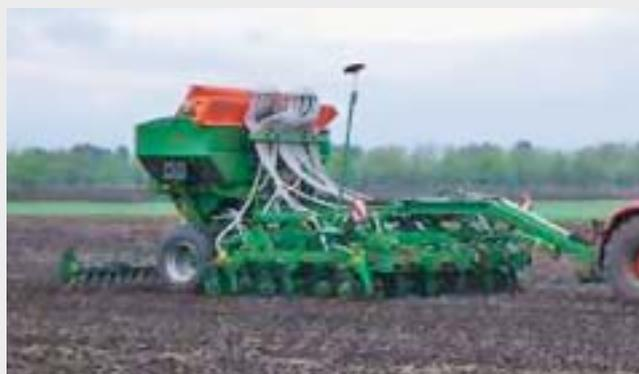
**Рис. 8:** Посев экспериментальных делянок сеялкой DMC 4500: закладка варианта опыта с междурядьем 75 см и внесением удобрений 5 см сбоку и 5 см глубже семян (18 мая 2009 г.)
