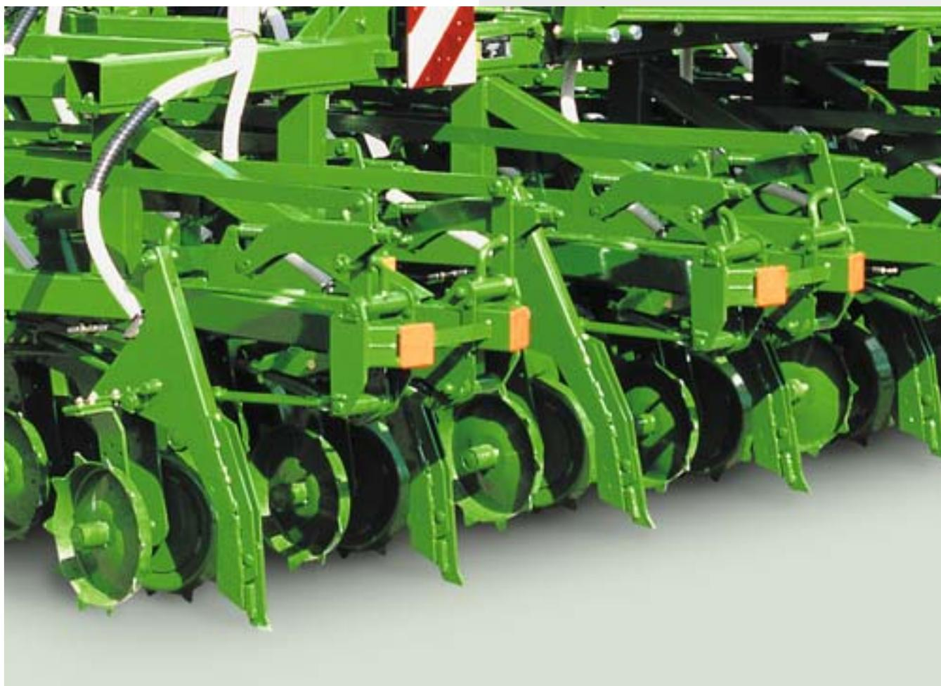
Благодаря этим пластинкам наши сеялки «Primer» обрабатывают многие 1.000 га! – зачастую носки сошников (которые к тому же еще легко меняются) можно использовать дальше даже после 10.000 га. При этом они работают по принципу зубов бобра, то есть передняя сторона твердая и относительно тонкая, за ней находится более мягкая сталь, благодаря чему долотовидные рабочие органы (как зуб бобра) постоянно сохраняют свою относительную остроту и вследствие этого могут легко проникать в землю.
