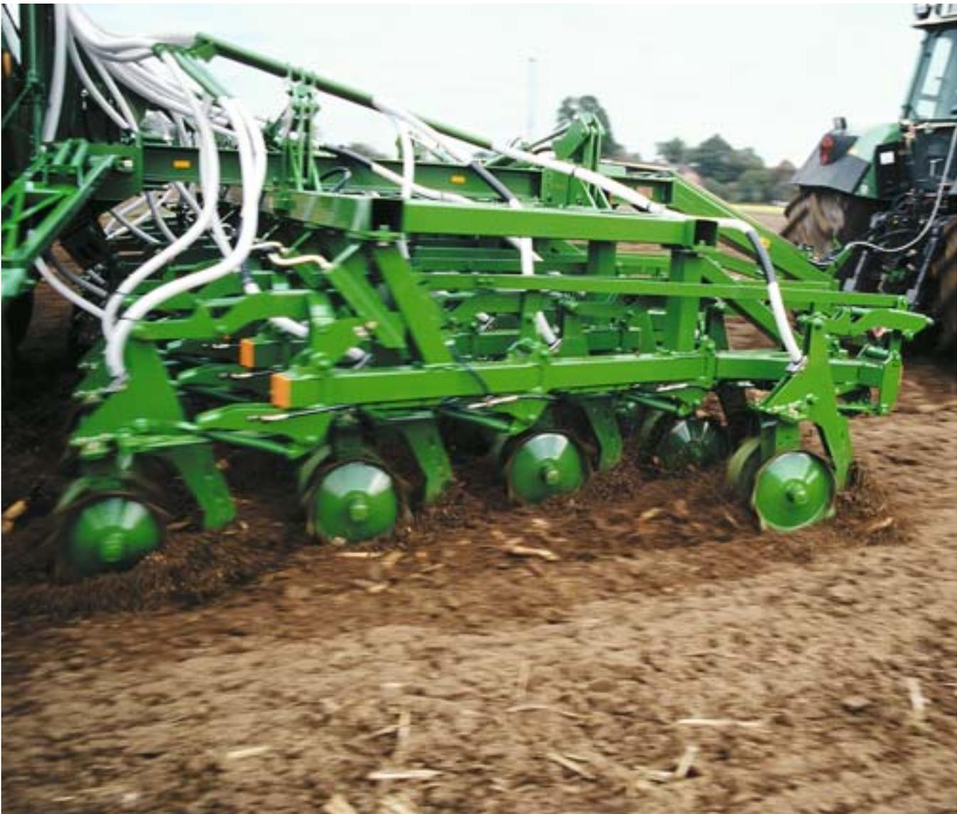
Saatablage bringen. Ein erheblicher zusätzlicher Vorteil entstand noch dadurch, dass jetzt die Primera DMC praktisch unbegrenzt schnell gefahren werden kann – bis zu 20 km/h sieht man keinen Unterschied. Gerade hier zeigte sich unsere jahrelang schon verteidigte Parallelogrammaufhängung der Schare als sehr vorteilhaft und eben optimal.
