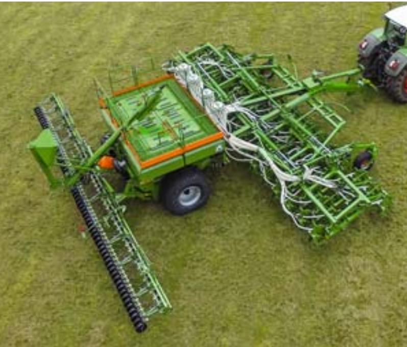
Inzwischen haben wir für die 12 m Arbeitsbreite – erforderliche Schleppergröße 400–500 PS – die „DMC 12001“ entwickelt und sie **versuchsweise** zum Einsatz gebracht.
