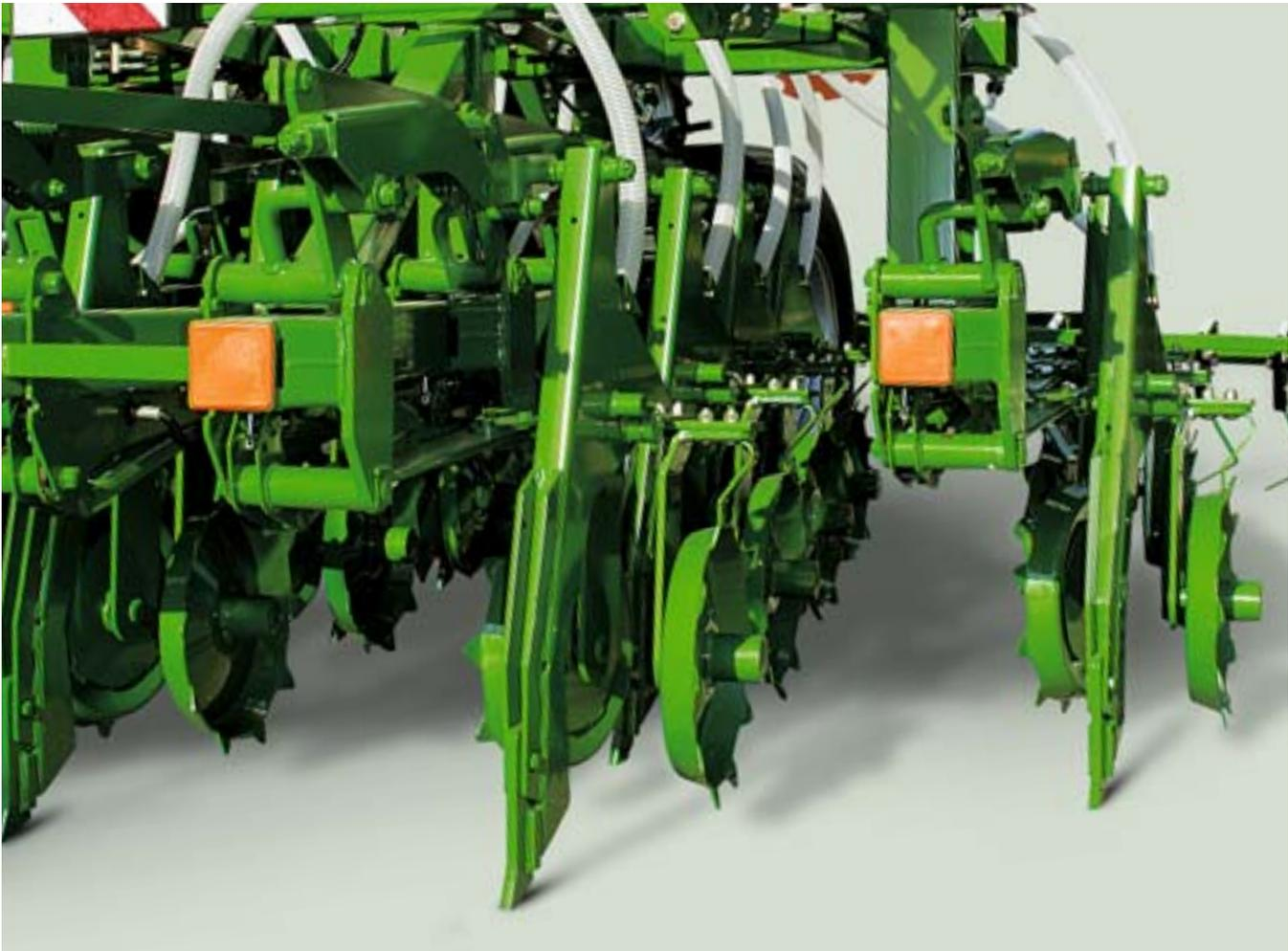
Die Anordnung der Schareinheiten an Längstraversen 4-reihig hintereinander ergibt einen großen Abstand zueinander. So wird eine gute Strohdurchlässigkeit gewährleistet.
