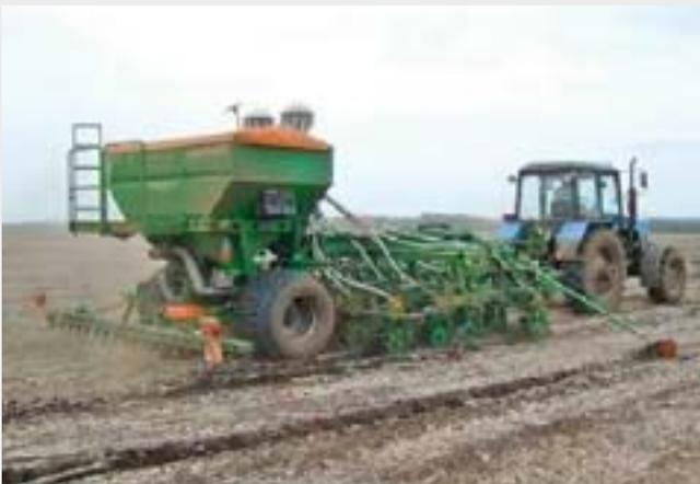
**Abb. 5:** Probegang mit DMC 4500, Reihenabstand 75 cm und gleichzeitig Düngung nach dem Schema: 5 cm Verschiebung und 5 cm tiefer (8. Mai 2009).
