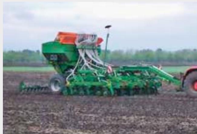
**Abb. 8:** Aussaat der Versuchspartellen mit DMC 4500: Versuchsanlage mit Reihenabstand 75 cm und Düngung: 5 cm Verschiebung und 5 cm tiefer (18. Mai 2009).
