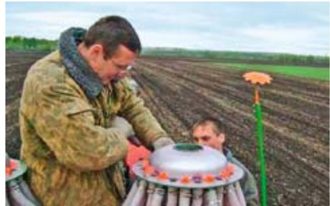
Abb. 9: Einrichtung der Sämaschine DMC 4500 zur Maisaussaat mit dem Reihenabstand 37,5 cm und gleichzeitiger Düngung (Ingenieur Sergey Vinogradov, Schlepperfahrer Evgeny Trifonov), 18. Mai 2009.
