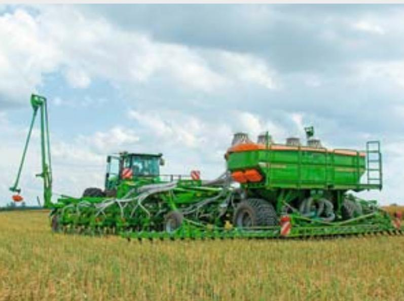
Schon gleich nach dem erfolgreichen Einsatz unserer DMC 9000 (mit 9 m Arbeitsbreite) wurde der Wunsch auch nach einer 12 m Arbeitsbreite für Schlepper in der 400 PS-Klasse an uns herangetragen ... und schon in diesem Sommer/Herbst 2009 läuft die erste 12 m-DMC in Russland.
