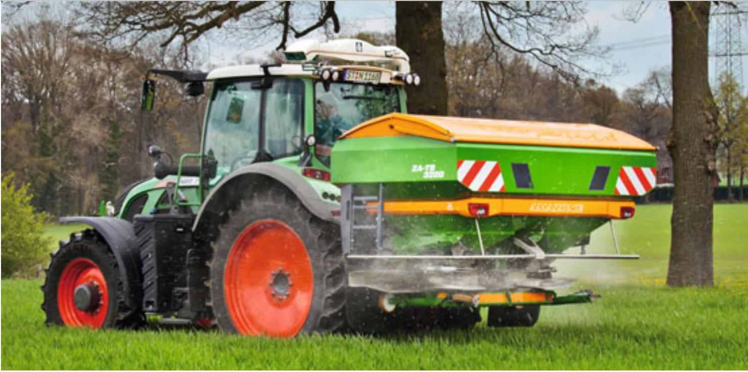
Düngerstreuer ZA-TS und N-Sensor für die teilflächenspezifische Düngung.
