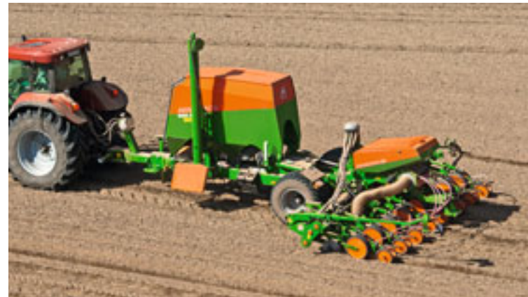
Einzelkorn-Sämaschine EDX 6000-T mit 8 Reihen und 6 m Arbeitsbreite.
