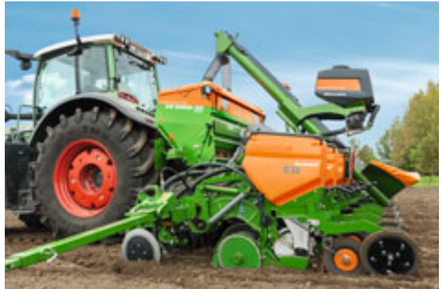
ED 6000-2C Super mit Düngertank, 8 Reihen und 6 m Arbeitsbreite.
