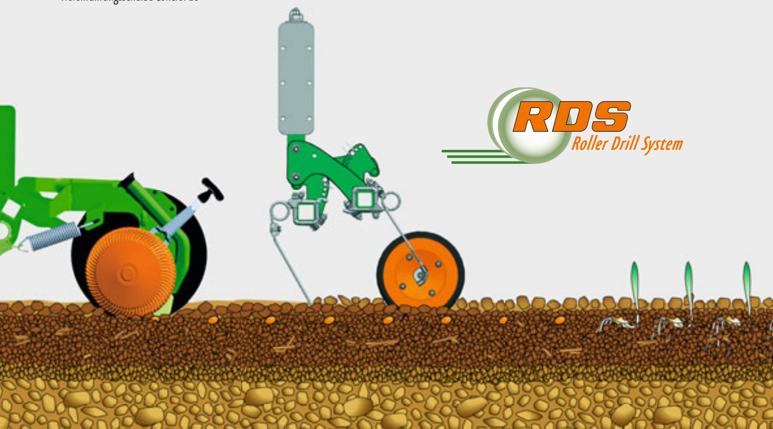
Einscheibenschar RoTeC-Control mit Tiefenführungsrolle Control 25 oder Tiefenführungsscheibe Control 10
