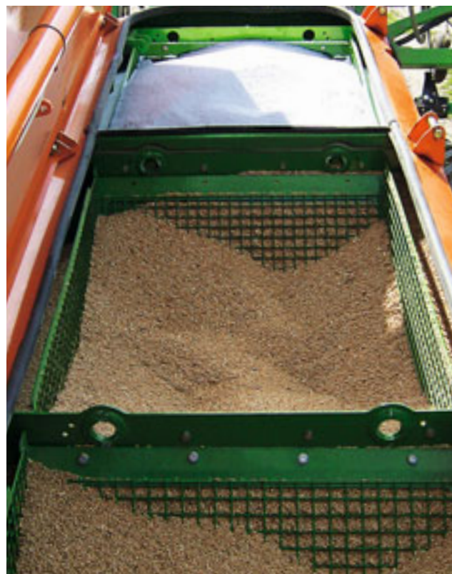
Zweigeteilter Behälter bei der Citan 12001-C und 15001-C.
