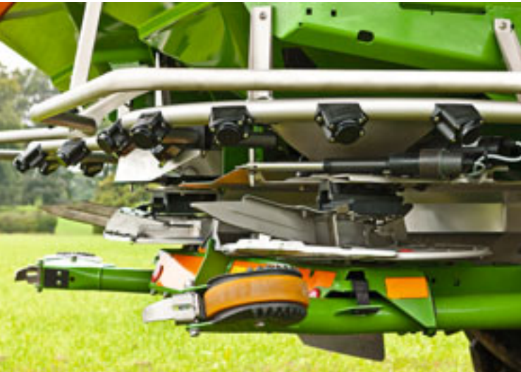
Argus-System zur Streufächererfassung.
