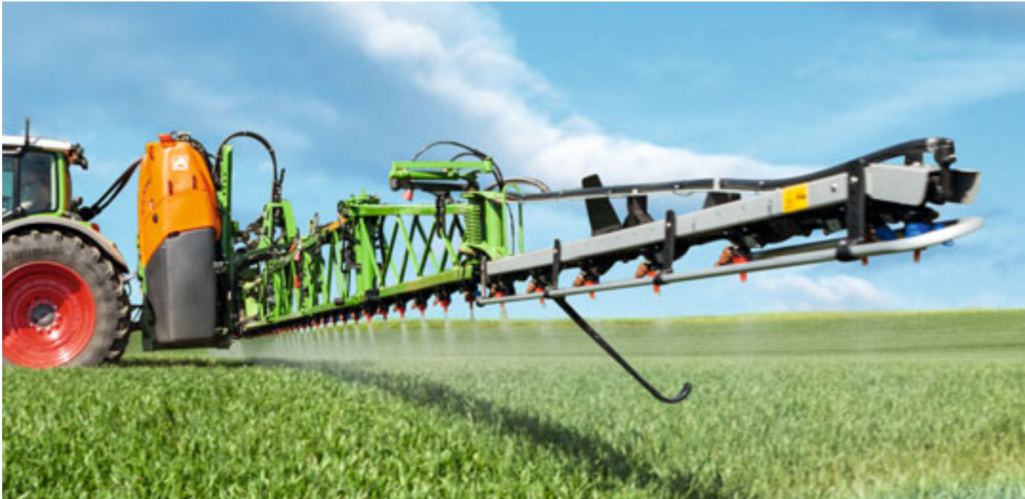
Anbauspritze UF 2002 mit 30-m-Super-S2-Gestänge.
