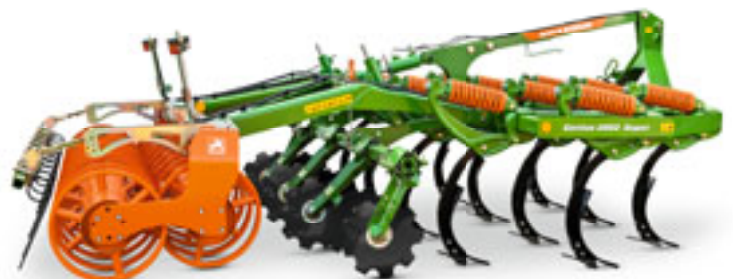
Cenius 3003 Super: 11 C-Mix-Super-Zinken mit Druckfeder-Überlastsicherung und Doppel-U-Profilwalze.
