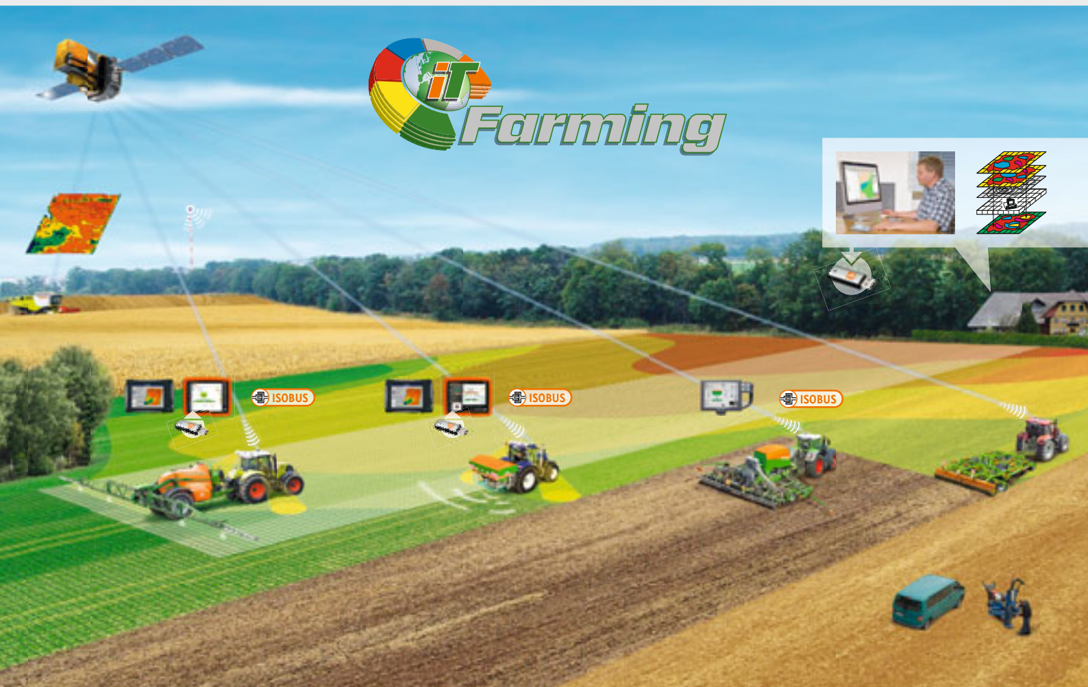
Abb. 12: Der Datenaustausch zwischen dem Bedienterminal AMATRON 3 oder AMAPAD und anderen IT-Farming-Technologien erfolgt über definierte und offen gelegte Schnittstellen
