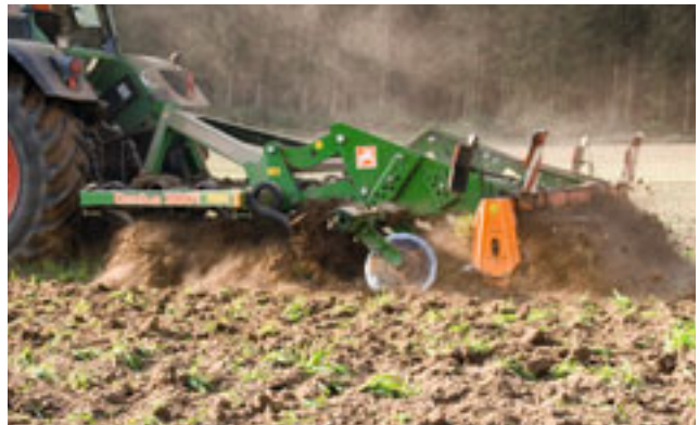
Aufgabe des Genius-Grubbers ist die tiefere Bearbeitung der Böden.
