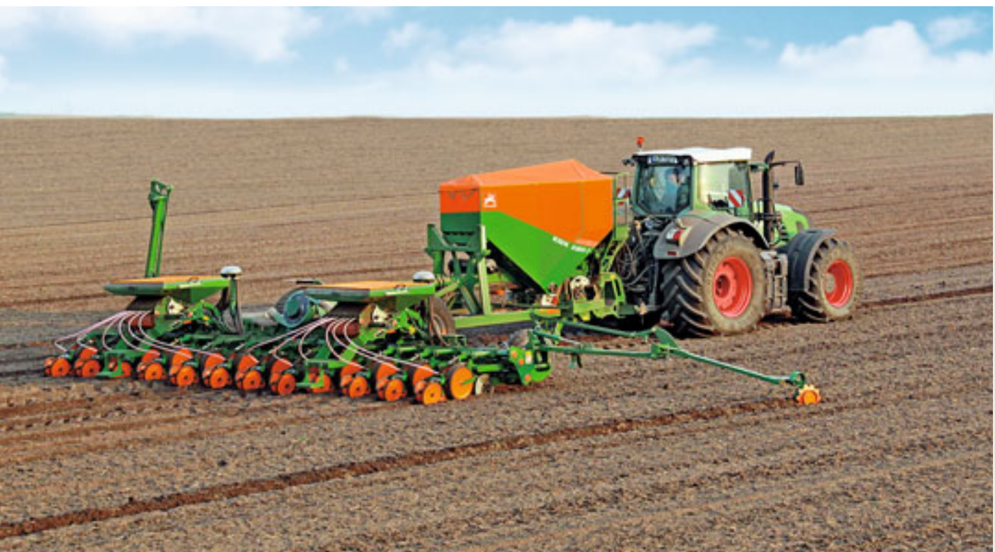
Einzelkorn-Sämaschine EDX 9000-T mit 12 Reihen und 9 m Arbeitsbreite.
