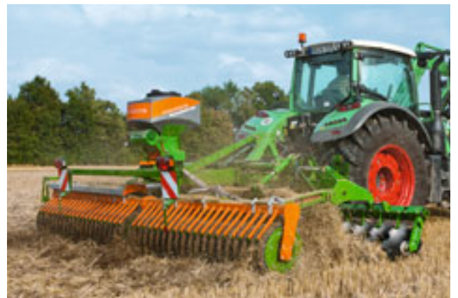
Kompaktscheibenegge Catros+ 5002-2 in 5 m Arbeitsbreite mit gezackten Scheiben (510 mm Durchmesser).
