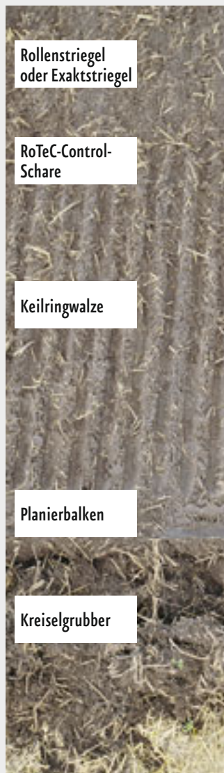
Abb. 7: Arbeitsweise der aktiven Säkombination: Stroheinmischung, Saatbettbereitung und Saat in einem Arbeitsgang
