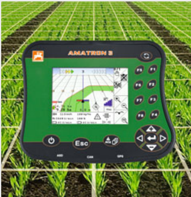
Abb. 13: GPS-Switch ermöglicht eine vollautomatische Vorgewende- und Teilbreitenschaltung von Feldspritzern und Düngerstreuern.
