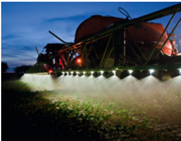
Eine Beleuchtungsanlage am Gestänge oder eine LED-Einzeldüsenbeleuchtung erleichtern die Arbeit bei Dunkelheit.
