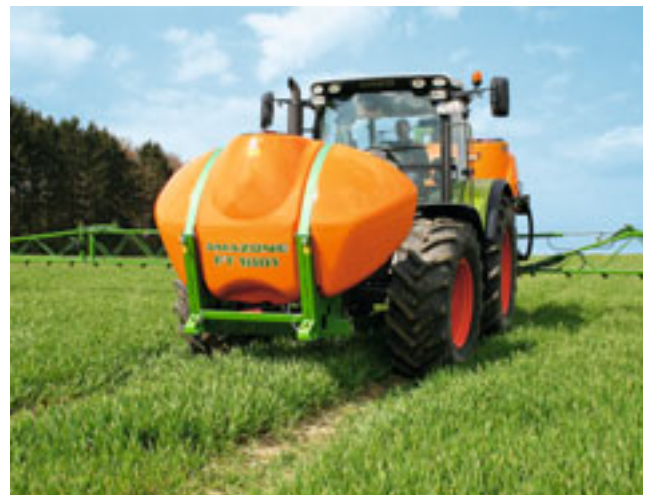
Der Fronttank FT erhöht die Kapazität der Anbaufeldspritzen UF um 1.000 l auf bis zu 3.000 l.
