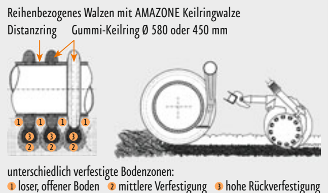
Abb. 14: Arbeitsfolge einer Kombination von Kreiselgrubber, Keilringwalze und RoTeC-Scharen
