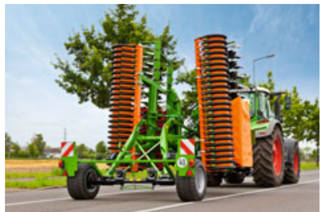
Kompaktscheibenegge Catros+ 5002-2 in 5 m Arbeitsbreite mit gezackten Scheiben (510 mm Durchmesser).
