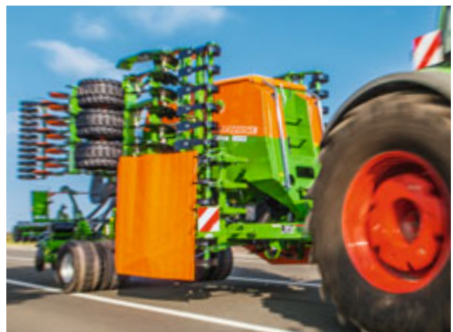
Sowohl die Cirrus- als auch die Citan-Sämaschinen können in kürzester Zeit auf 3 m Transportbreite zusammengeklappt werden.
