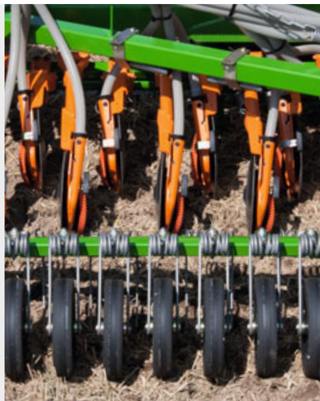
Für den Einsatz auf Trockenstandorten können die Citan-Sämaschinen mit einem Rollenstriegel ausgerüstet werden.
