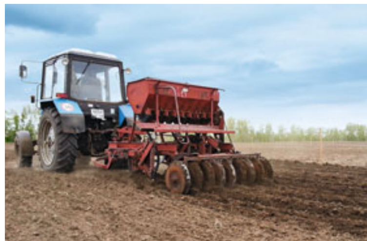
Verfahren 3: C3C2.1 mechanische Flügelschärsämaschine mit 2,1 m Arbeitsbreite am Belarus MTS 82.1 (80 PS).
