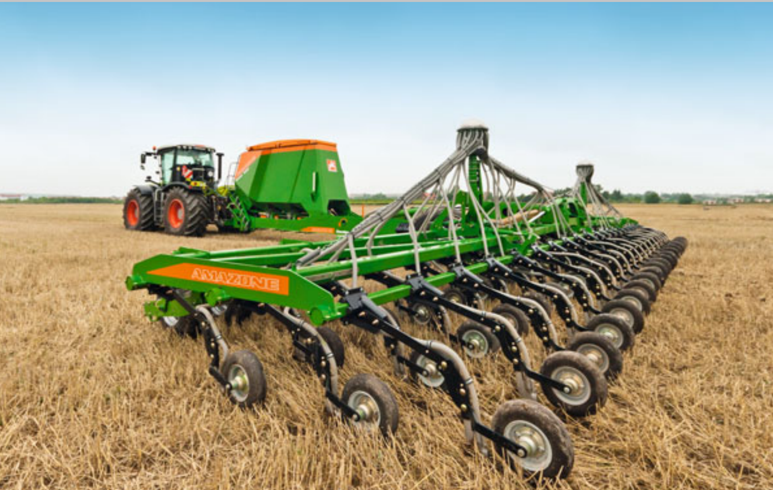
Großflächensämaschine Condor mit 12 m Arbeitsbreite.
