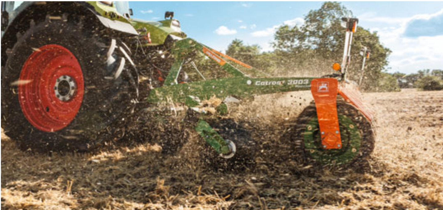
Kompaktscheibenegge Catros+ 3003 Special mit gezackten Scheiben in 3 m Arbeitsbreite.
