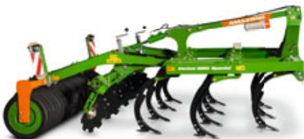
Cenius 3003 Special: 11 C-Mix-Special-Zinken mit Scherbolzen-Überlastsicherung und Keilringwalze.
