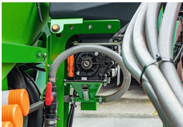
Die Dosierung erfolgt komfortabel über einen elektrischen Dosierantrieb direkt unterhalb des Saatgutbehälters
