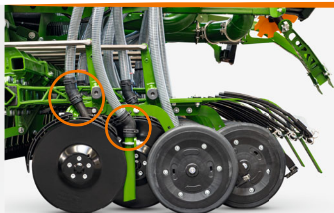
TwinTeC-Schar mit zusätzlichem Auslauf
