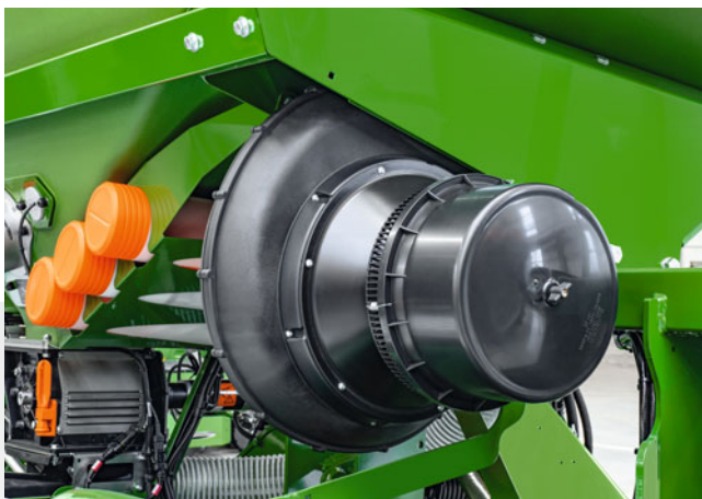
Der optionale Zyklonabscheider reduziert die Staubbelastung
