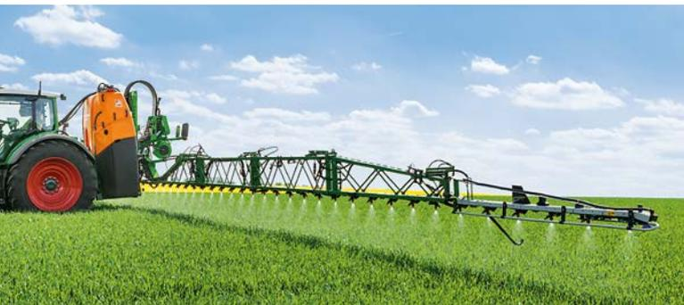
Die neue Anbauspritze UF 2002 mit 2.000 l Nennvolumen bieten wir zukünftig oberhalb der bestehenden UF 01-Produkttypen an. Bei den gezogenen Pflanzenschutzspritzen bringen wir mit der UX 01 Super neue Maschinen mit Behältergrößen von 4.200 l, 5.200 l oder 6.200 l sowie Super-L2-Gestänge mit Breiten von 27 bis 40 m auf den Markt. Nicht nur das tolle Design dieser Spritzen ist neu, auch die Technik haben unsere Konstrukteure bis ins Detail erneuert.
