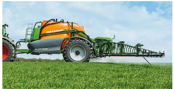
So sorgt die aktive Gestängesteuerung ContourControl für eine sehr gute vertikale Gestängeführung. Die wichtigsten Komponenten dieses Systems sind ein besonders schnell agierendes Hydrauliksystem sowie sechs Ultraschallsensoren, die gleichmäßig über die Arbeitsbreite des Gestänges verteilt sind.
