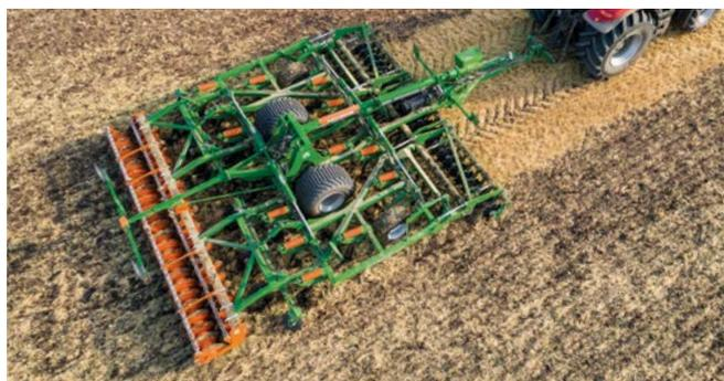
Scheibeneggen-Grubber-Kombination Ceus noch einmal entscheidend ausgebaut. Nach dem Zukauf der Pflugfabrik von Vogel & Noot bieten wir außerdem ein sehr breites Pflugprogramm an, zu dem mit dem neuen Typ Hektor jetzt auch ein Aufsatteldrehpflug mit bis zu 8 Scharen gehört.
