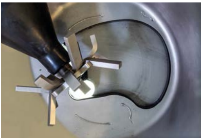
Stufe 1: Trichteröffnung wenig geöffnet
