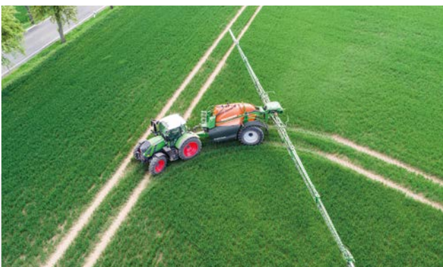
✔ Mit Lenkwinkeln von 28° meistern die Lenkachsen auch erstklassig enge Kurven.
