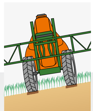
Aktivierte Hangsteuerung der AutoTrail-Lenkung
