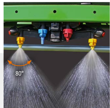
Elektrische Einzeldüsen-schaltung AmaSelect mit 4-fach-Düsen-träger und 50 cm bzw. 25 cm Düsen-abstand
