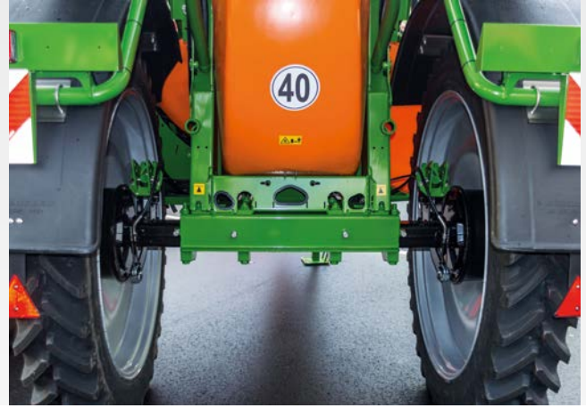
Verstellachse mit einer stufenlosen Spurweitenverstellung von 1,50 m bis 2,25 m für die UX 4201
