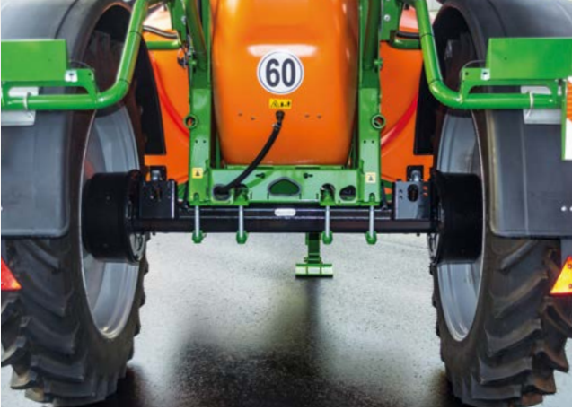
Festachse mit Spurweiten von 1,50 m bis 2,25 m
