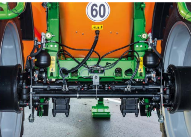
Hydropneumatische Achsfederung mit AutoTrail-Achsschenkellenkung für die UX 4201 und UX 5201
