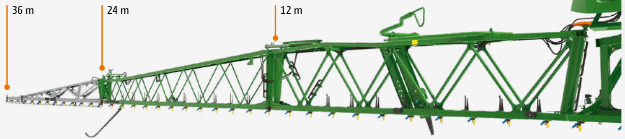
Super-L3-Gestänge mit einer Arbeitsbreite von 36 m, reduzierbar auf 24 m und 12 m
