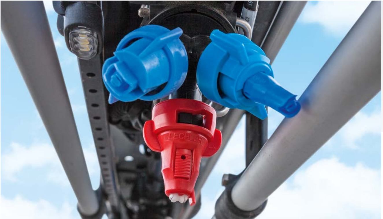
AmaSwitch 3-fach-Düsen-träger mit LED-Einzeldüsen-beleuchtung
