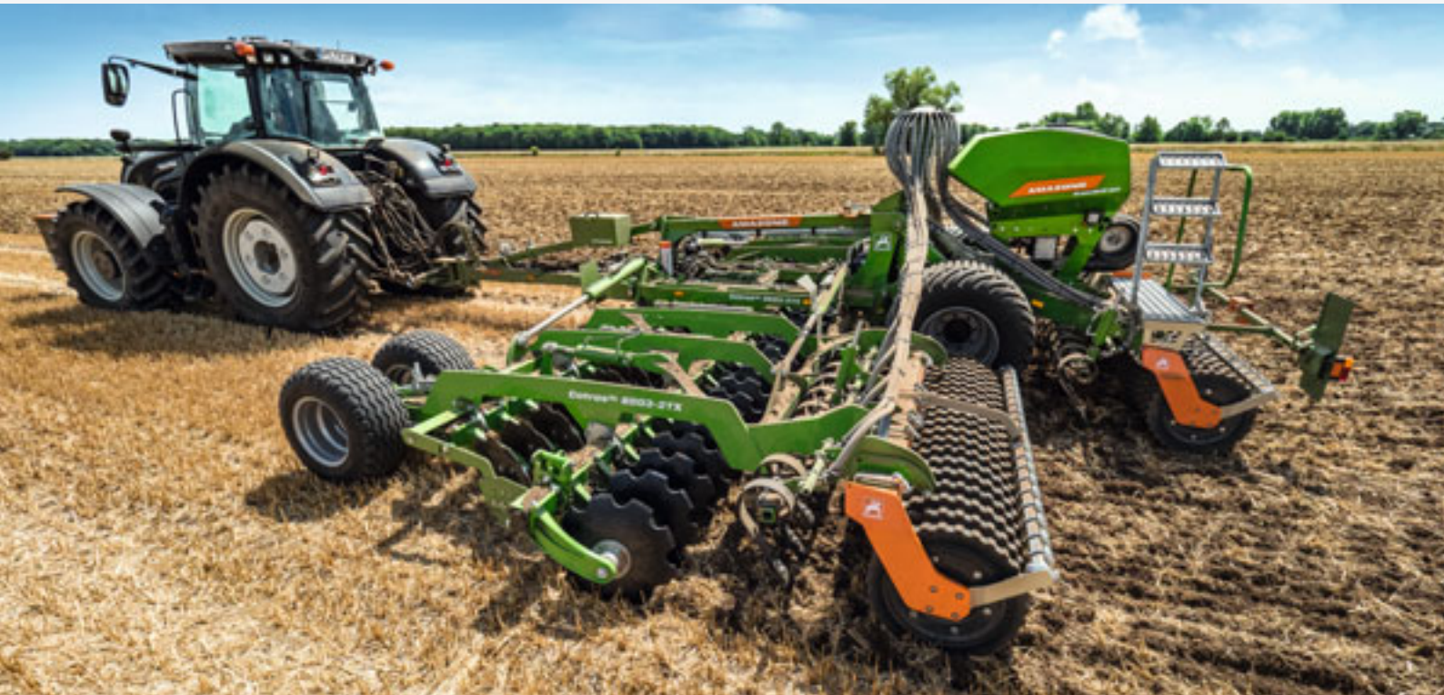
Catros XL 8003-2TX beim Stoppelsturz mit aufgebauter GreenDrill zur Zwischenfruchtsaat
