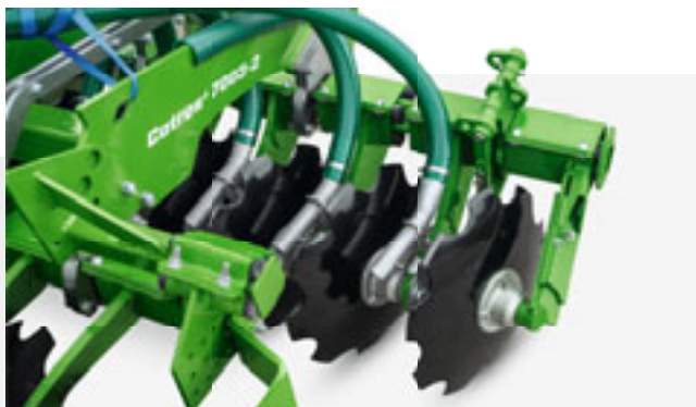
Gülleausbringung hinter der ersten Scheibe
