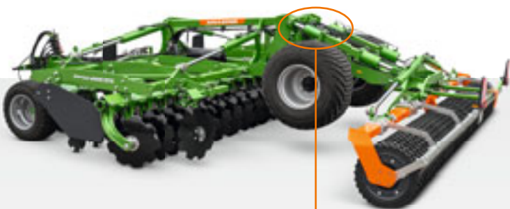
Hydraulischer Obergurt an der Certos 6002-2TX
