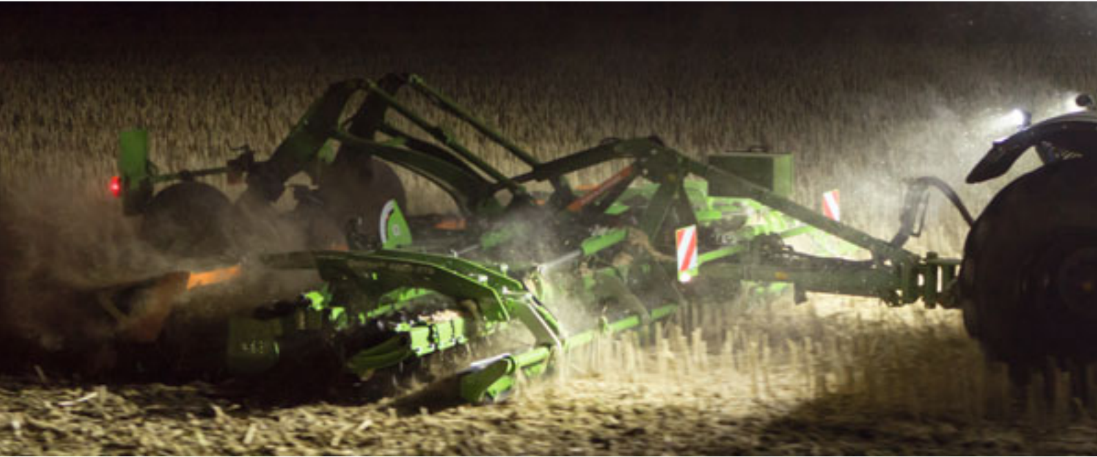
Catros XL mit Messerwalze in Rapsstoppeln
