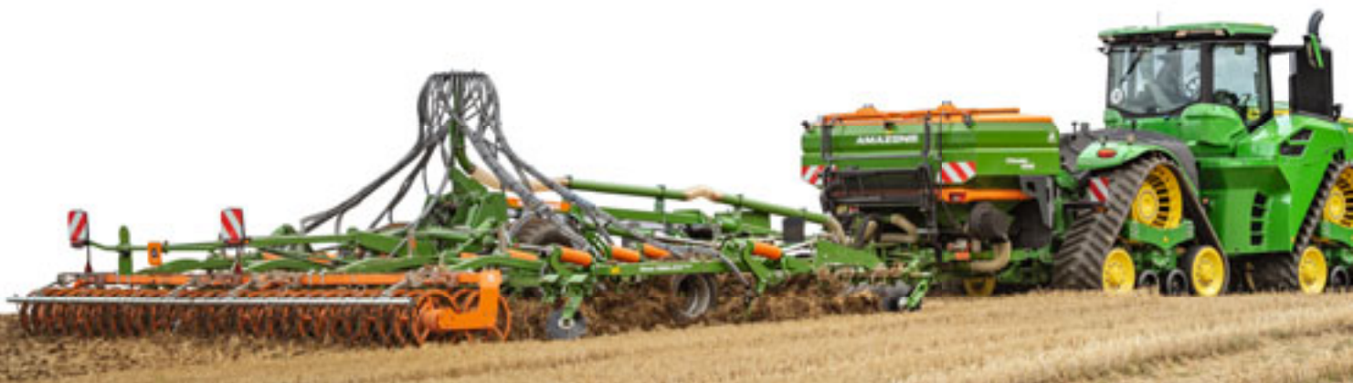
Anbaubehälter XTender 4200 mit 4.200 l Behältervolumen mit Ceus 7000-2TX
