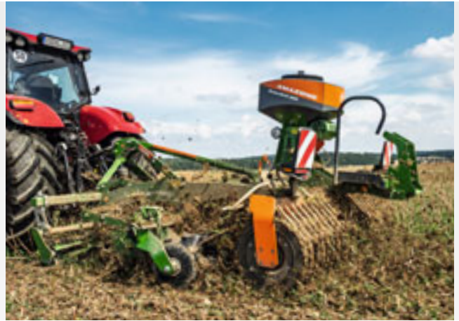
Catros XL 3003 mit X-Cutter-Disc, Messerwalze und GreenDrill
