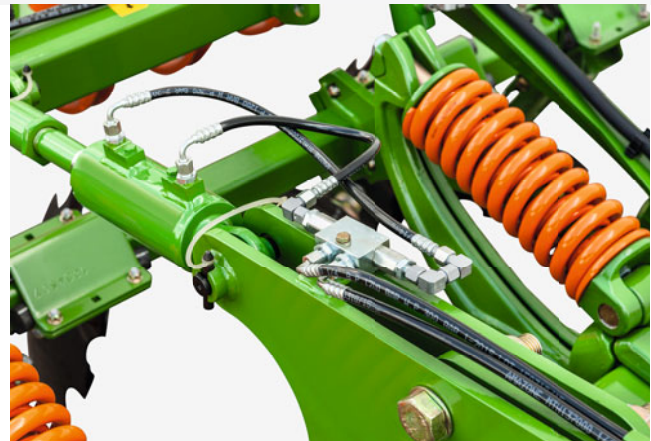
Zylinder zur Tiefenverstellung des Zinkenfeldes
