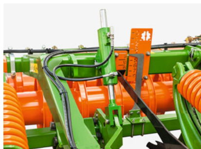
Zylinder zur Tiefeneinstellung der Einebnungseinheit
