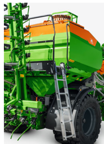
Gute Erreichbarkeit aller Behälter durch Leiter und Laufsteg
