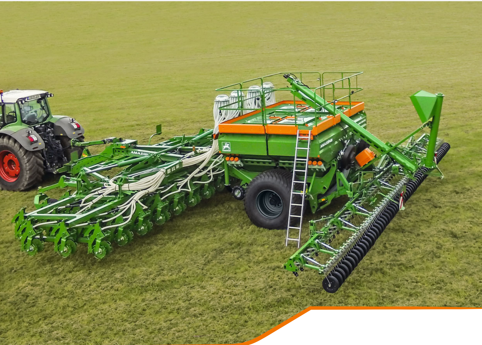
Primera DMC 12001-2C mit Befüllschnecke
