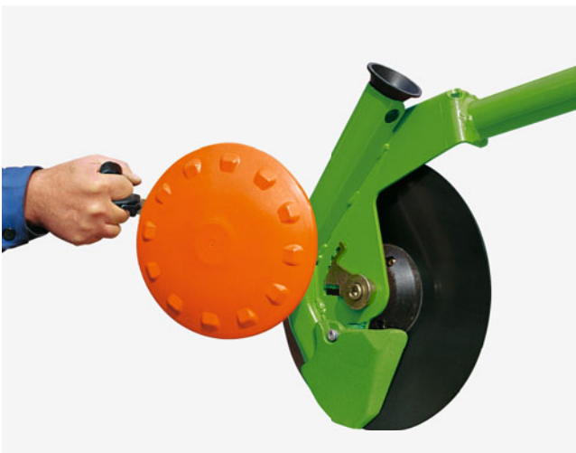
✓ RoTeC-Schar (Ø 320 mm) mit Tiefenführungsscheibe Control 10
