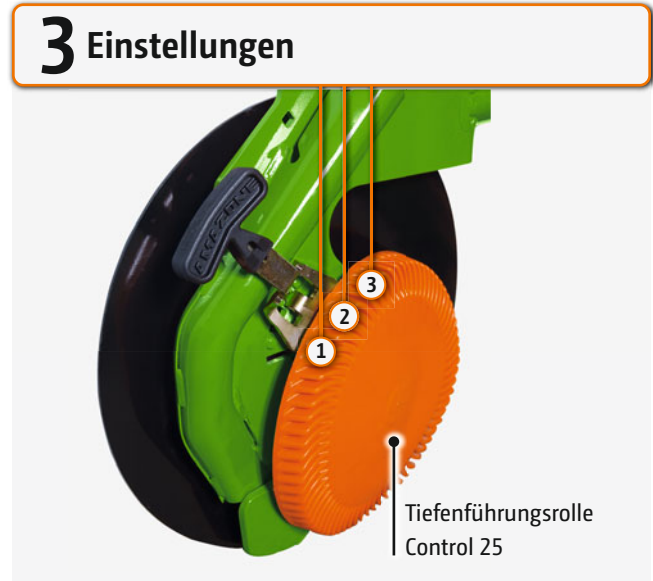
✓ RoTeC-Schar (Ø 320 mm) mit Tiefenführungsrolle Control 25 Die rückwärtig geöffneten Lamellen sorgen für eine sehr gute Eigenreinigung.
