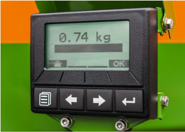
Kalibrieren über das TwinTerminal 3.0
