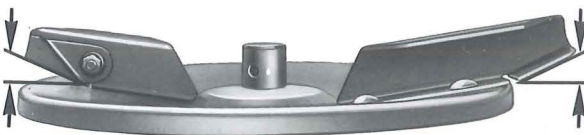
fig. 2b Overbemesting strooien: Zwenkschoepen omhoog „B“ en strooier kort boven net gewas.
