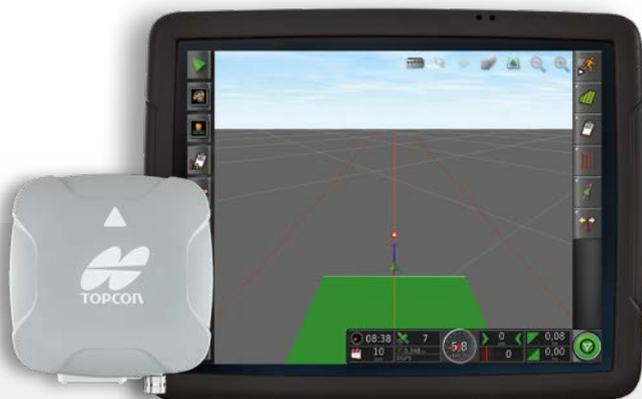
ISOBUS-Terminal TopCon X35 mit Empfänger AGS-2 für die automatische Spurführung und Teilbreitenschaltung
