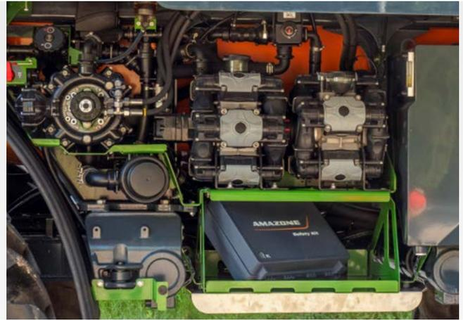
Die Spülwasserpumpe (160 l/min) befindet sich neben den zwei leistungsstarke Kolbenmembranpumpen
