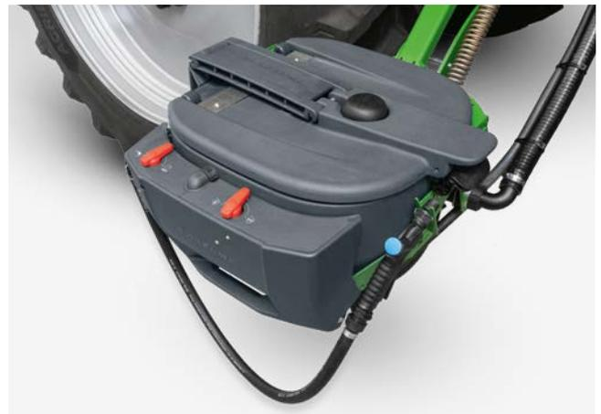
Der geschlossene Einspülbehälter kann zur Selbstreinigung durchgespült werden.
