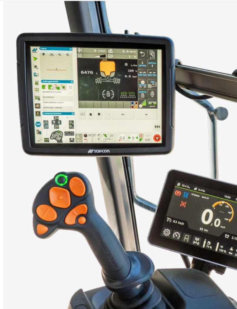
Zwei-Terminal-Lösung mit ISOBUS-Terminal TopCon X35 und Fahrzeug-Terminal AmaDrive 7.0 sowie Multifunktionsgriff AmaPilot<sup>+</sup>
