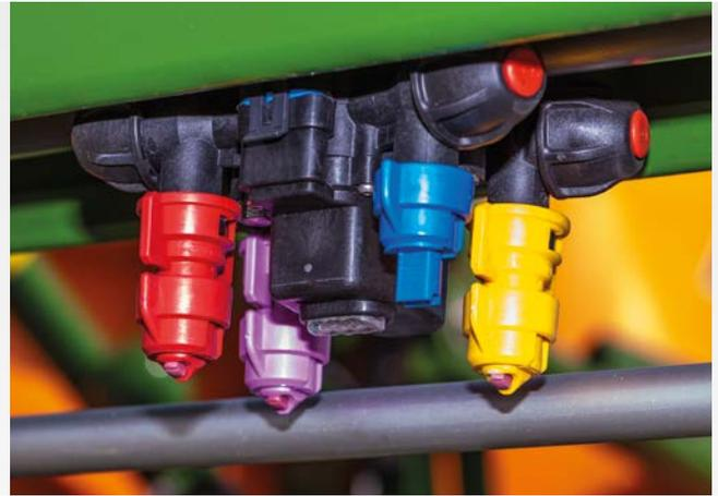
✓ Elektrische Einzeldüsensteuerung AmaSelect
