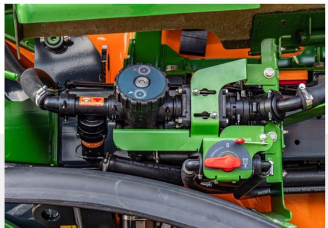
✓ HighFlow<sup>+</sup> ist mit einem zusätzlichen, selbstreinigenden Druckfilter ausgestattet
