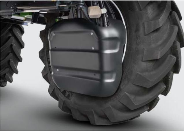
Radmotorenabdeckung an der Pantera-H und Pantera-HW
