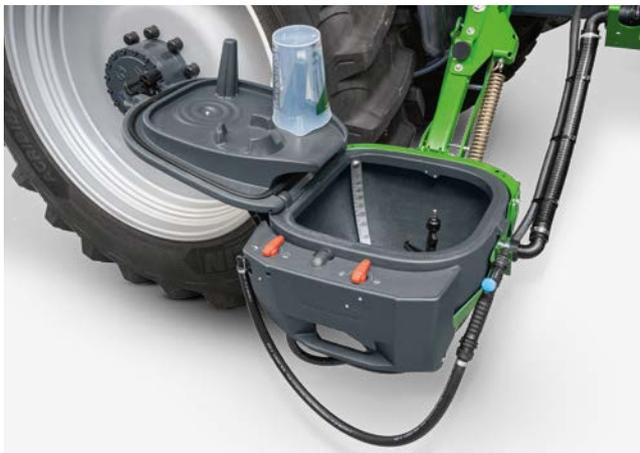
Der Deckel verfügt über Halter für Messbecher oder Spritzmittelkanister, um diese nach dem Spülen auslaufen zu lassen.
