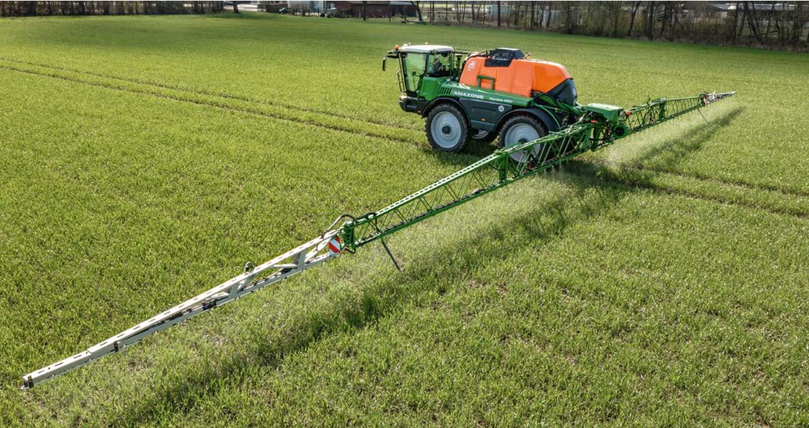
Großer Höhenverstellbereich von 0,35 m bis 2,65 m über das gefederte Parallelogramm (an Pantera 4504 mit Bereifung 380/90 R50)
