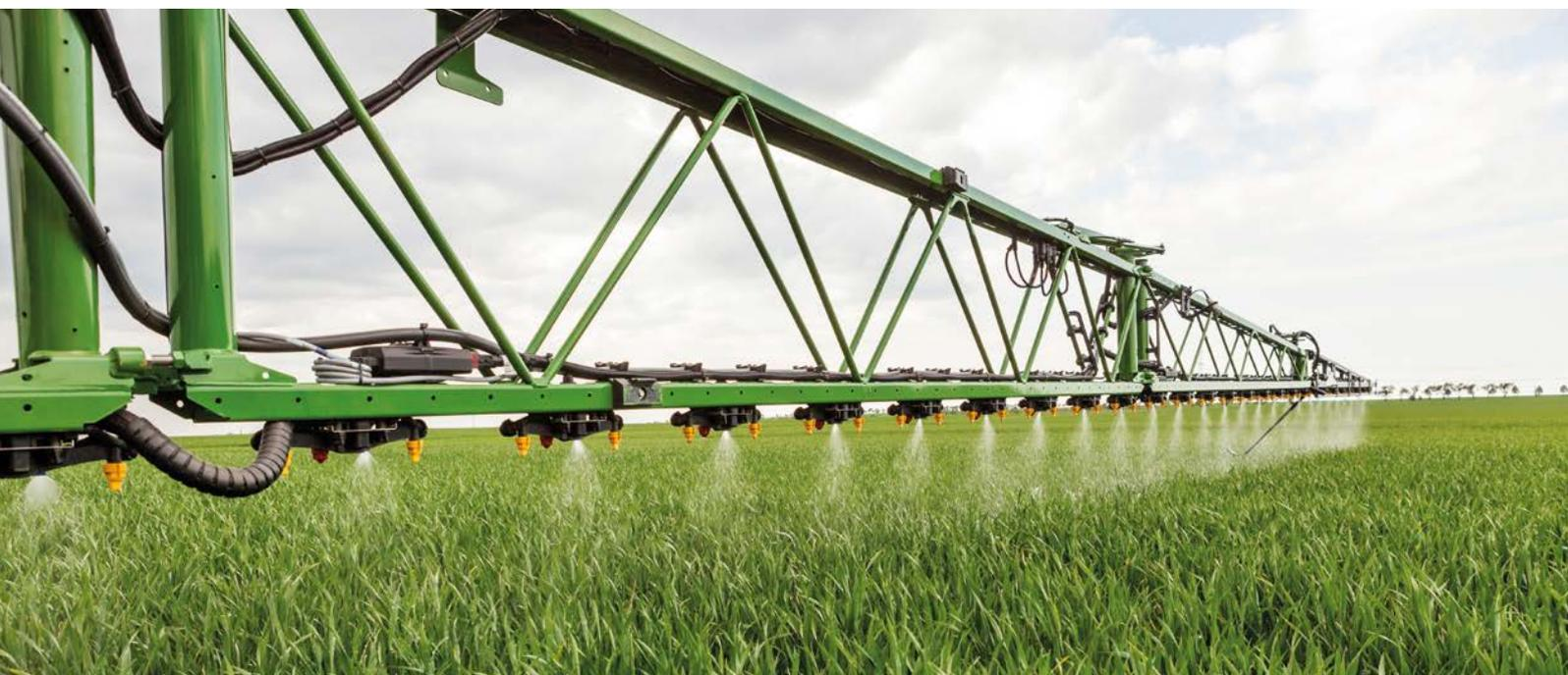
Schleppschlauchausstattung an Einzeldüsenchialtung AmaSwitch mit 4-fach-Düsenkörper und Verlagerungssatz am Super-L2-Gestänge
