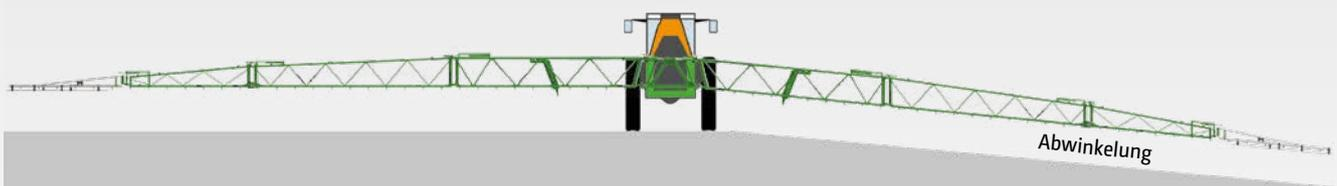
Abwinkelung (über Flex-Klappung 2 in Kombination mit ContourControl)
