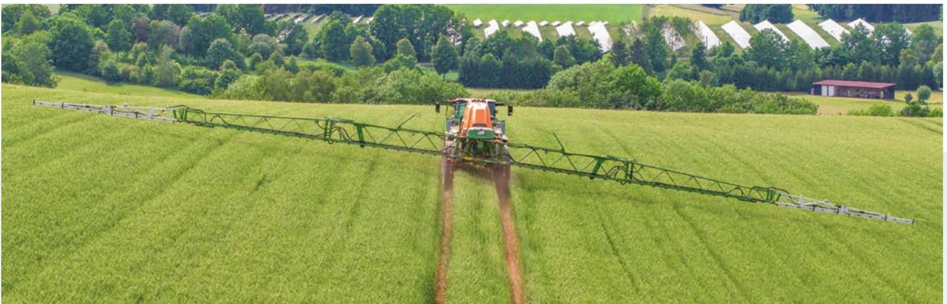
Niedrige Kippgefahr in kuppertem Gelände dank automatischem Hangausgleich
