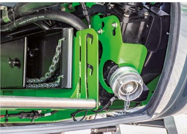
✓ Befüllanschluss im Ablagefach mit automatischem Befüllstopp
