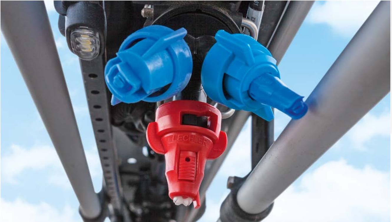
AmaSwitch 3-fach-Düsenträger mit LED-Einzeldüsenbeleuchtung
