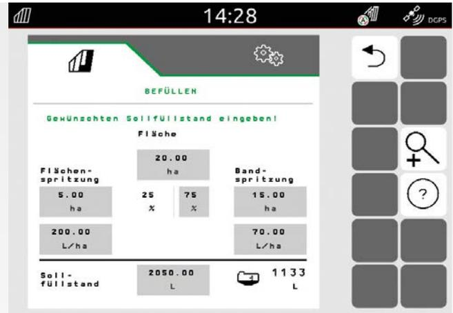
Hilfreiches Befüllmenü zur Ermittlung der benötigten Füllmenge
