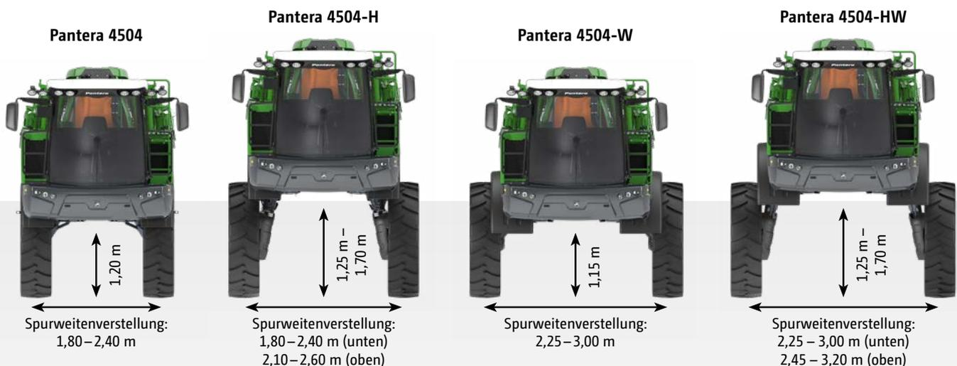
Spurweite und Bodenfreiheit jeweils mit Bereifung 380/90 R50 (Einpresstiefe + 50 mm)
