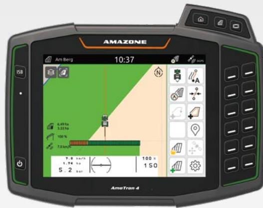
Durch ein exaktes Schalten werden mit GPS-Switch Überlappungen am Vorgewende oder in Keilen vermieden.
