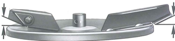
Fig. 2b Spätdüngung: Schwenkflügel hochgestellt „B“
