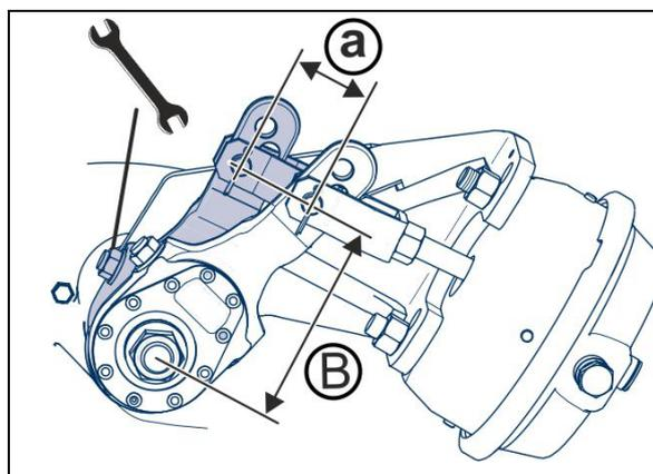
**Comprobar la función del ajustador automático del varillaje**
