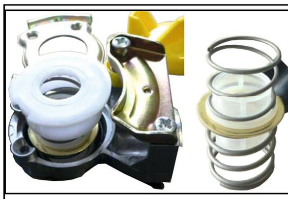
**!** Colocar la junta tórica correctamente en el anillo de plástico.
