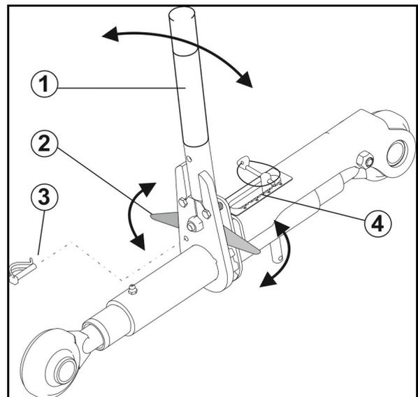
La escala (4) sirve para la orientación durante el ajuste
