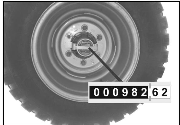
$$\text{Superficie [ha]} = 0,1 \times \text{valor indicado [km]} \times \text{anchura de trabajo [m]}$$
