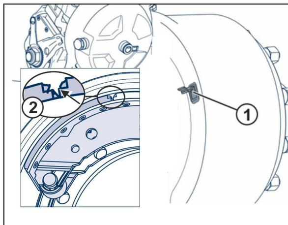
**Ajuste en el ajustador del varillaje (trabajo de taller)**
