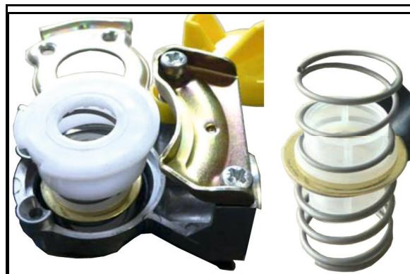
**!** Poziționați corect inelul O pe inelul de material plastic.
