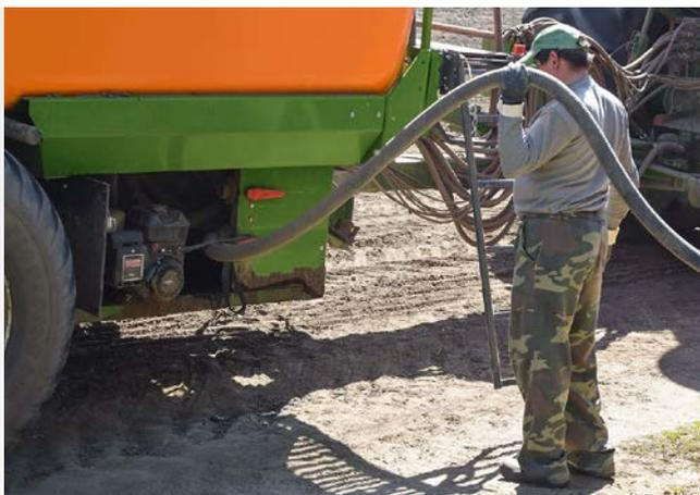
Remplissage rapide avec 500 l/min.
