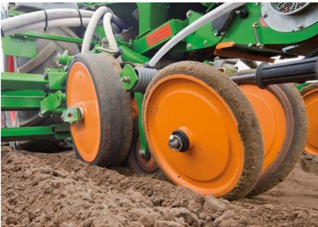
Roues d'appui et fermeture de sillon avec les roues de rappui Super-V
