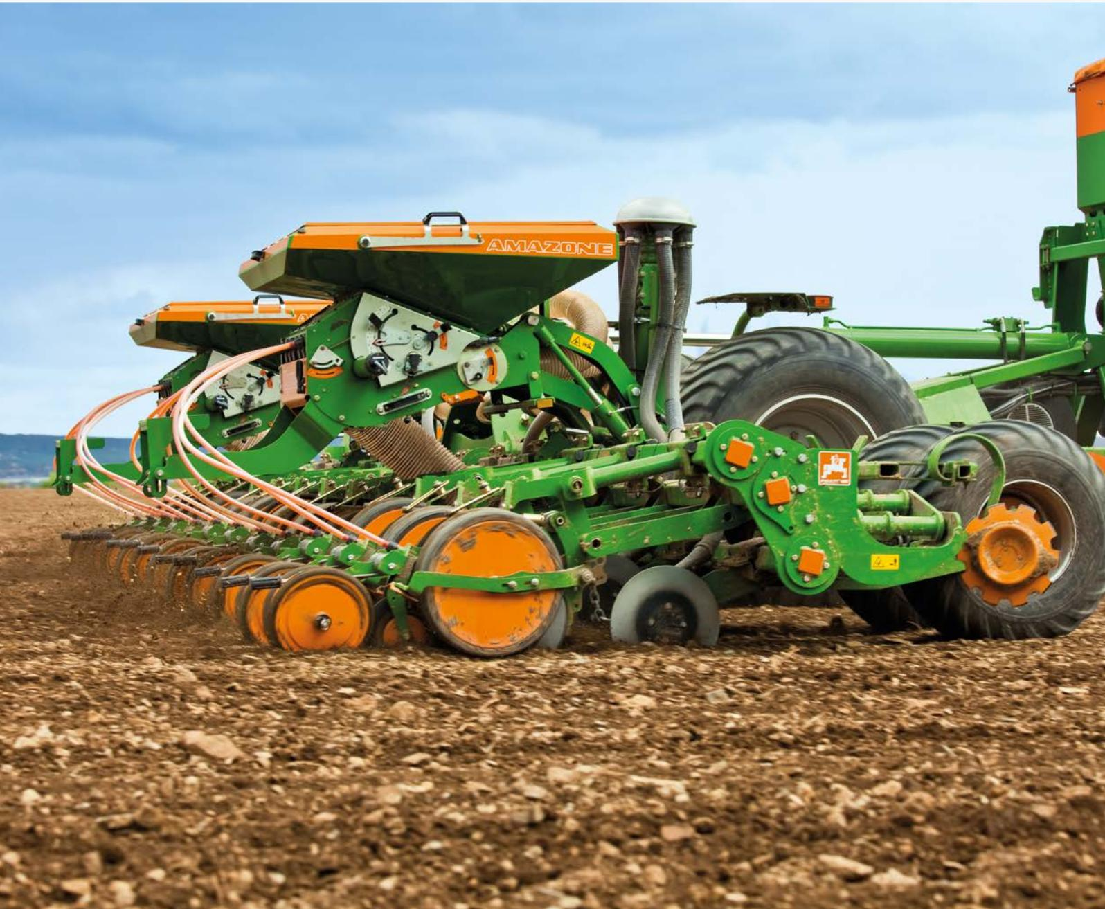
❗ « Lors de notre test, le système d'éléments semeurs de l'EDX a fourni un travail vraiment bon dans toutes les conditions. Même pour le semis mulch et sur des sols lourds, la technique de semis a implanté avec une profondeur fiable l'engrais et la semence. »
