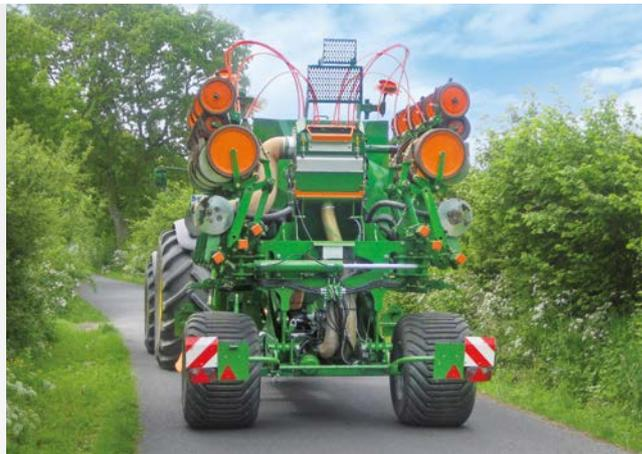
Grâce à un mécanisme de repliage ingénieux, tous les semoirs monograinne EDX peuvent être repliés très rapidement pour les déplacements routiers, sur une largeur au transport de 3 m.
