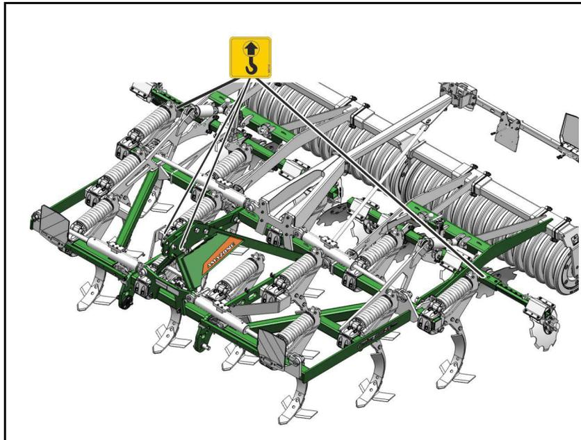
Die Maschine hat 4 Anschlagmittel zum Heben.
