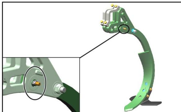
Ersatz-Scherschrauben und Muttern für Zinken bei Cenius Special am Rahmen befestigt.
