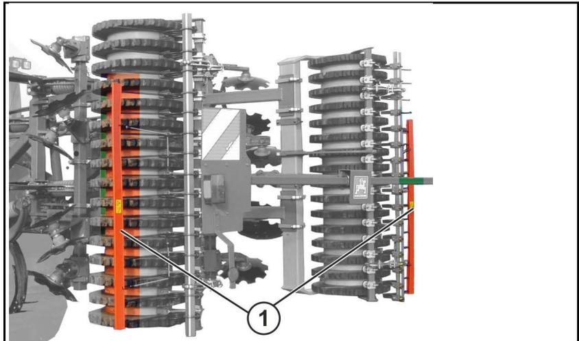
(1) Verkehrssicherungsleiste am Heckstriegel beim Straßentransport.
