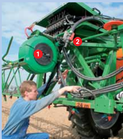
Stabile Aufhängung, vierfach gedämpft. Aber: Reinigungsset (1) und DUS-Absperrhahn (2) sitzen am Turm und sind bei eingeklapptem Gestänge kaum erreichbar.
