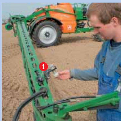
Via Ultraschallsensoren (1) führt Distance-Control (2400 €) das Gestänge automatisch. Der Fahrer wird enorm entlastet und fährt schneller. Ein Muss für die UX.
