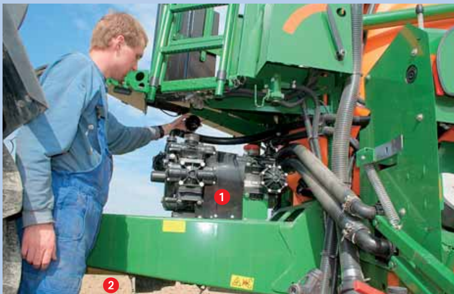
Der Pumpen-Doppelpack (1) mit 250 + 180 l/min ist Standard. Der Antrieb von unten (2) erhöht die Bodenfreiheit.
