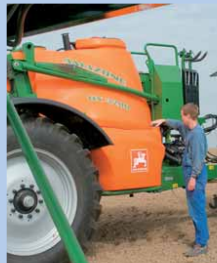
Der 320-l-Klarwassertank lässt sich einfach befüllen – per Schlauchanschluss auch von links. Allerdings verdeckt er die Sicht des Fahrers auf den Reifen.
