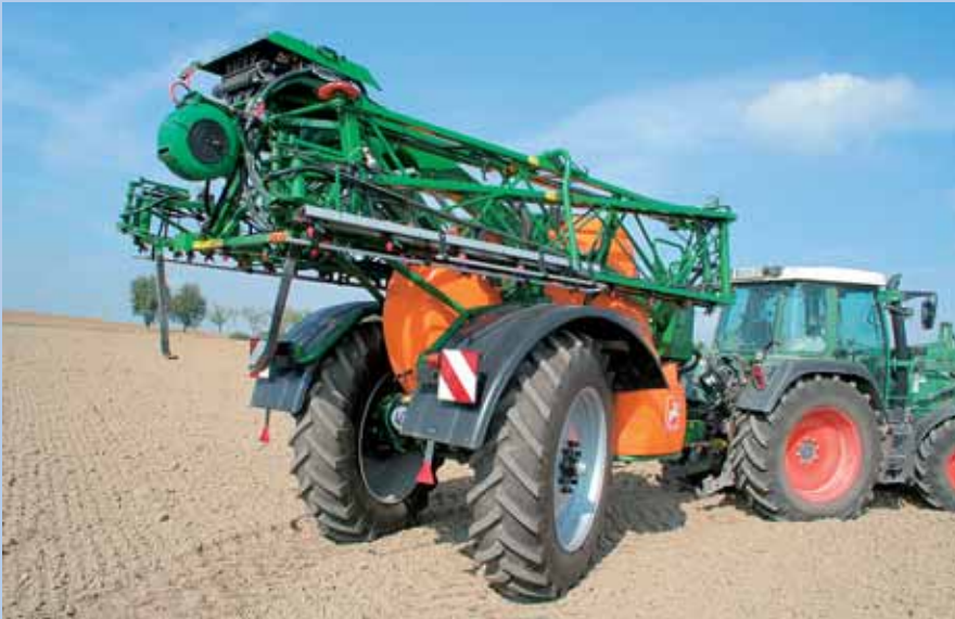
Die Achsschenkellenkung für 5750 € erhöht die Wendigkeit, ohne an Standsicherheit zu verlieren – prima.
