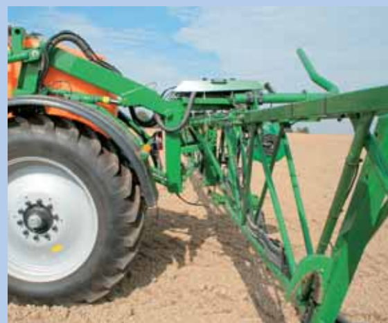
Das stabile Parallelogramm führt den Spritzbalken souverän. Bis 11 km/h sind bei ordentlichem Untergrund drin.
