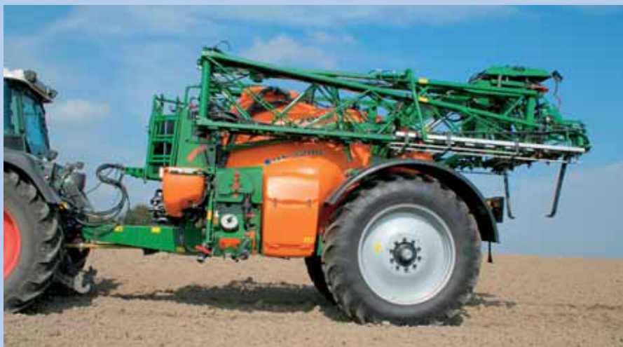
Die UX 3200 baut mit 615 cm Länge um 55 cm kürzer als die UX 4200 und die UX 5200. Das macht sie schön wendig.
