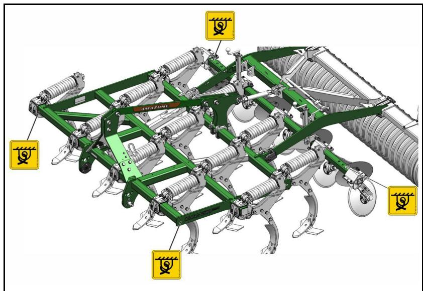
Stroj ovisno o opremi ima 4 točke za privezivanje za postavljanje opreme za privezivanje.
