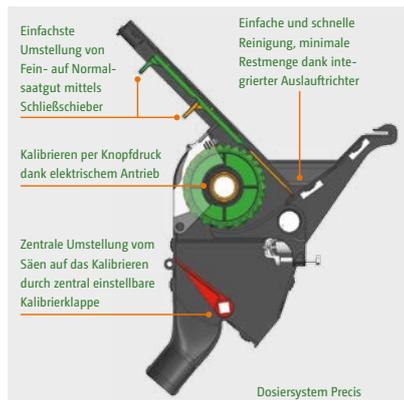
So sorgt z. B. ein neues Dosiersystem mit elektrischem Antrieb für eine präzise Dosierung des Saatgutes, und auch die Umstellung von Normal- auf Feinsaat wurde erheblich vereinfacht.
