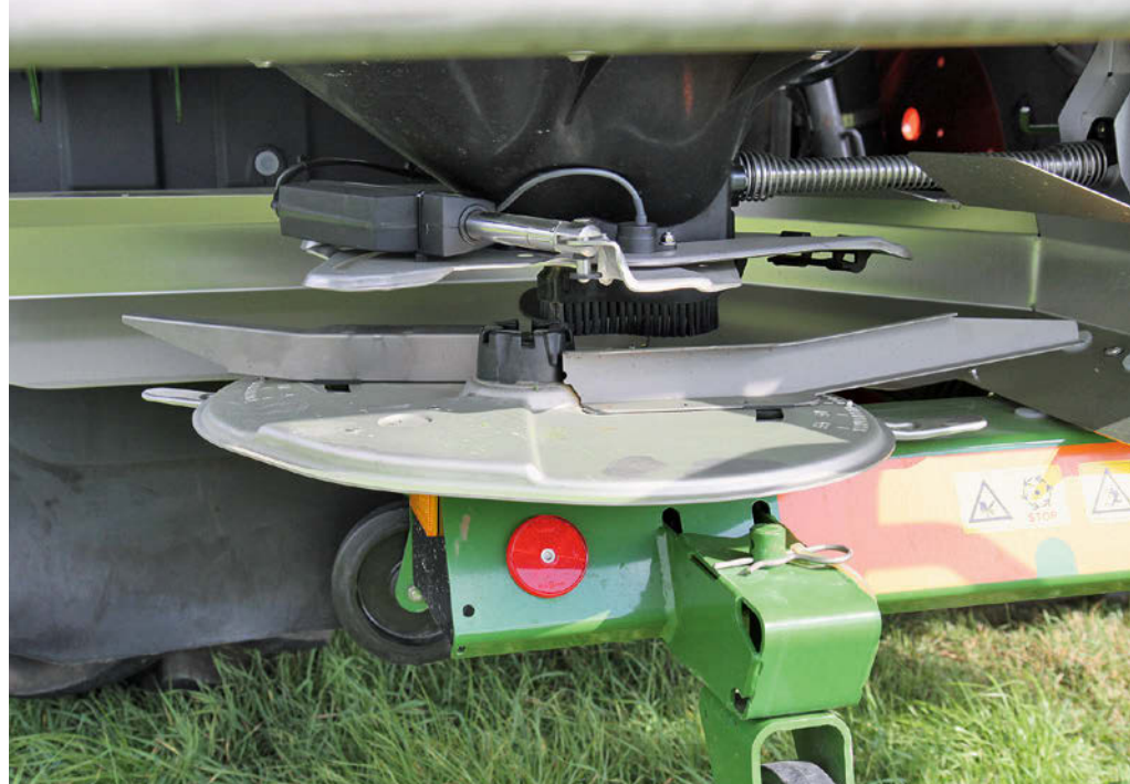
Je eine kurze und eine lange Schaufel mit speziellen Anstellungswinkeln werfen den Dünger in verschiedene Höhen, um die Präzision auch bei größeren Arbeitsbreiten sicherzustellen.
