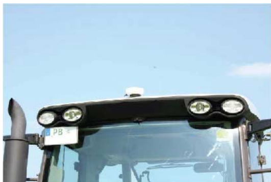
GPS-приёмник на крыше трактора
