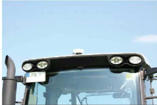
Récepteur GPS sur le toit d'un tracteur
