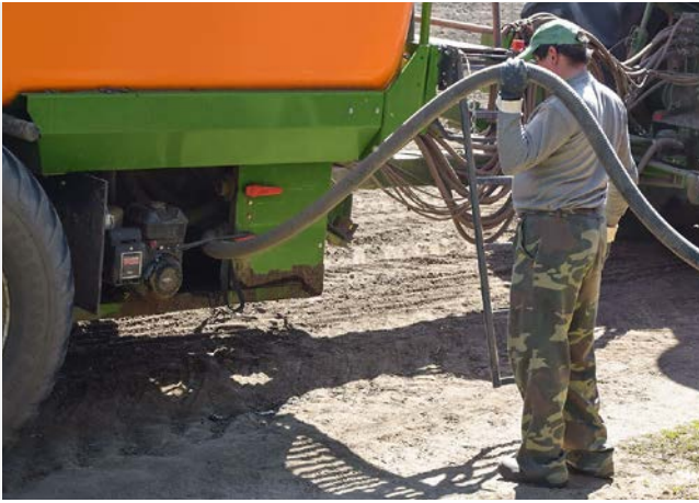
Schnelle Befüllung mit 500 l/min.
