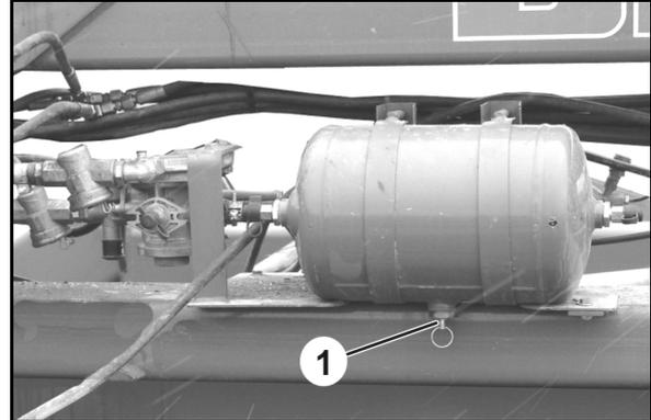
**Fig. 68****O reservatório de ar comprimido (1)**
