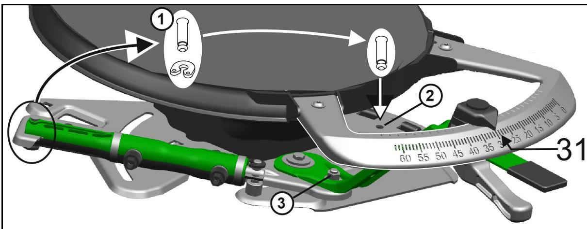
1. Снимите с гидроцилиндра палец (1).
