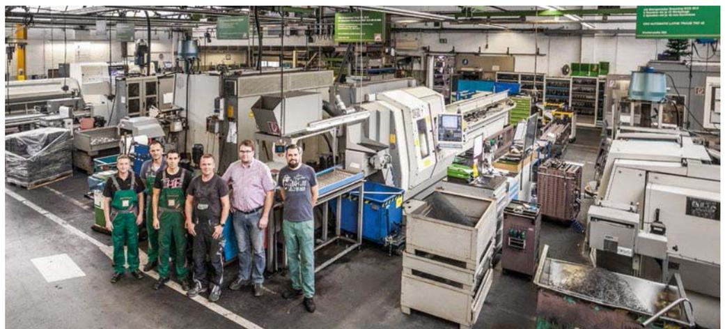
Maschinenbedienung, hoher Grad an Automatisierung, geringer Ausschuss und ein Dreischichtbetrieb ermöglichen eine dennoch kostengünstige Fertigung. Dazu fertigt die Amazone Automatendreherei flexibler und die Kosten für Qualitätssicherung und Logistik bleiben ebenfalls gering. Bei erhöhtem Arbeitsanfall werden auch Teile an Zulieferer vergeben, aber das wesentliche Know-how bleibt bei Amazone.
