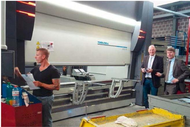
Vor ein paar Wochen ist im Stammwerk eine neue Abkantpresse aufgestellt worden. Wie die Typenbezeichnung schon vermuten lässt, hat die Presse eine Presskraft von 135 Tonnen und eine Arbeitsbreite von 3 Metern.
