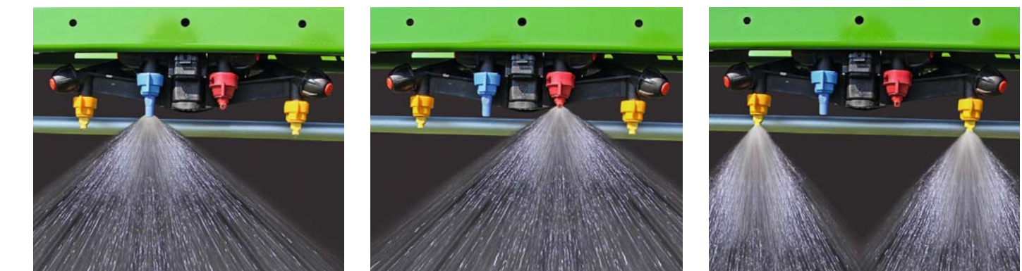
Sähköinen suutinkohtainen AmaSelect-kytkentä 4-suutinrungolla ja 50 cm tai 25 cm -suutinvälillä
