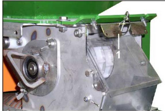
3. Injektorschleusenklappe (1) öffnen, damit das Saatgut / der Dünger in die Abdrehwanne fließen kann.
