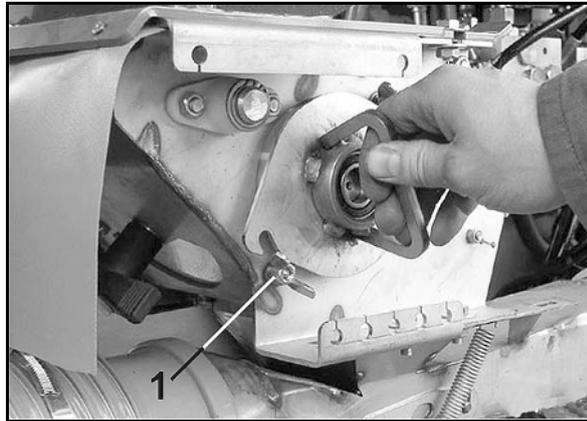
5. Dosierwalze aus dem Dosierer herausziehen.
