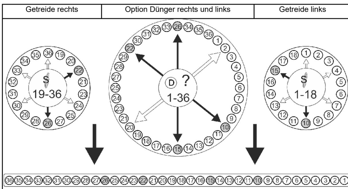
Bei Lieferung der Maschine und bei der Neuanschaffung des Pflege- traktors prüfen, ob die im Verteilerkopf eingestellte Fahrgasse auf die Spurweite des Pflege traktors eingestellt ist.
