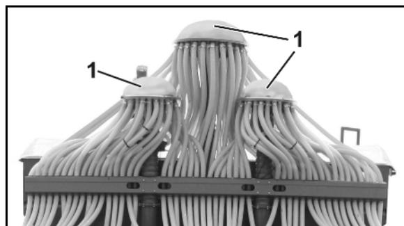
Mit der Fahrgassenschaltung im Verteilerkopf lassen sich Fahrgassen in vorwählbaren Abständen auf dem Feld anlegen. Zum Einstellen der unterschiedlichen Fahrgassenabstände müssen entsprechende Fahrgassen-Rhythmen in den Bordcomputer eingegeben werden.
