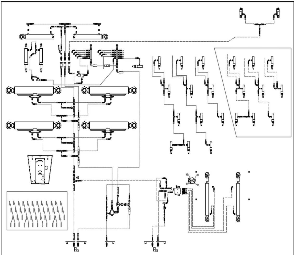
Bordhydraulik / Befüllschnecke
