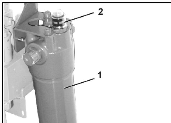
Ölfiler Bordhydraulik mit Verschmutzungsanzeige:
