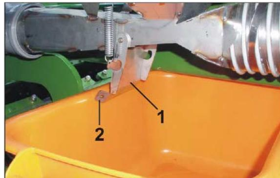
4. Reibrad (1), wie bei der Abdrehprobe mit der Abdrehkurbel so oft in Pfeilrichtung drehen, bis sich die Dosierräder und der Dosierer vollständig entleert haben.
