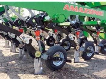
Forschung (BMBF) hat Amazone deshalb eine pneumatische Parzellensämaschine auf Basis der Primera DMC 3000 gebaut, die dank schmaler Meißel bei der Furchenöffnung sehr wenig Erde bewegt.
