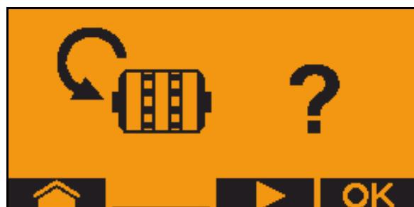
7. **OK** Подтвердить, что заслонка под дозирующим устройством открыта, и под ним установлена сборная емкость.
