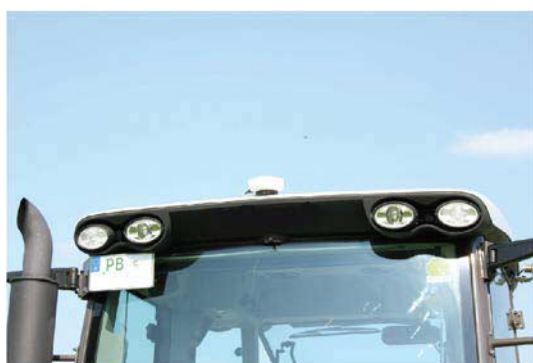
Приемник DGPS на крыше трактора
