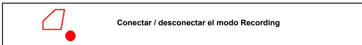
Con el modo Recording conectado, se puede grabar un límite de campo sin que la máquina esté en la posición de trabajo (dosificación interrumpida, no se sigue contando los carriles).
