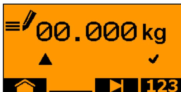
El puesto decimal seleccionado se muestra mediante una flecha.
