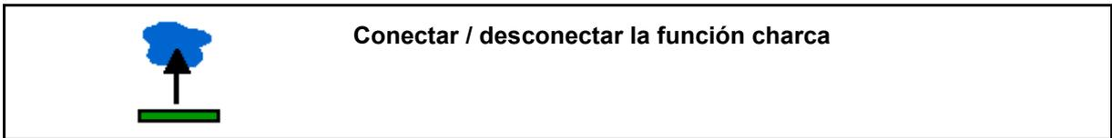
La función charca permite atravesar zonas con agua con la máquina levantada sin interrumpir la siembra.
