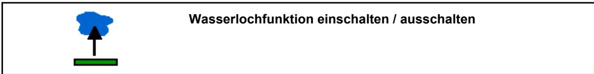
Die Wasserlochfunktion ermöglicht die Durchfahrt nasser Passagen mit ausgehobener Maschine ohne Unterbrechung der Aussaat.
