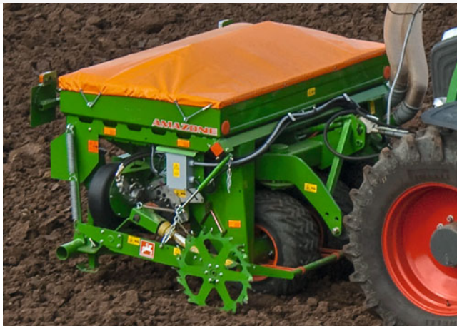
Zweispitziger Frontbehälter bei der 6 m breiten Avant mit mechanischem Dosierantrieb über Spornrad für zwei Verteilerköpfe
