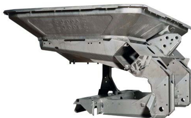
Geschweißt mit dem neuen Roboter: Rahmen und Grundbehälter ZA-V/ZA-TS
