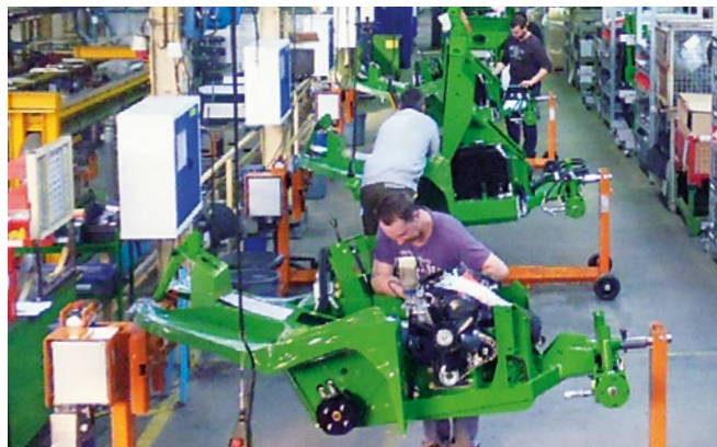
Die Montagelinie des Profihopper wird in Fließfertigung betrieben
