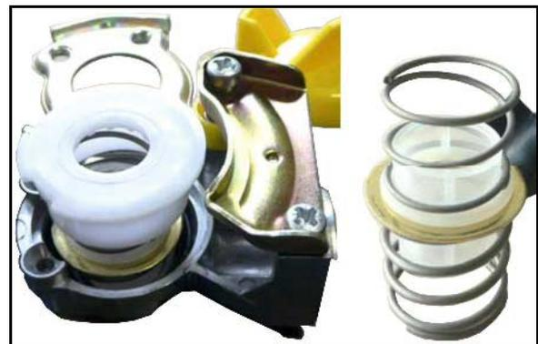
**!** O-Ring korrekt auf dem Kunststoffring positionieren.
