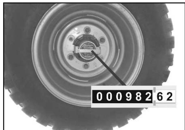
$$\text{Fläche [ha]} = 0,1 \times \text{Anzeigewert [km]} \times \text{Arbeitsbreite [m]}$$
