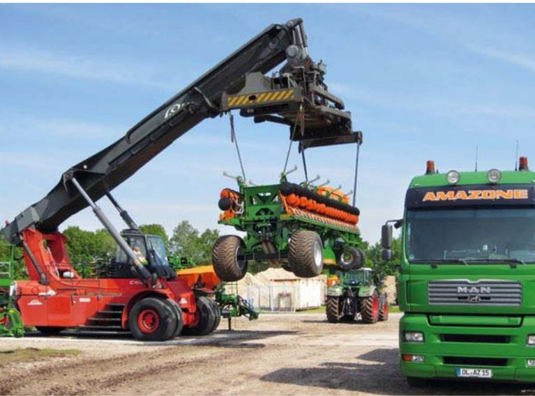
Eine Attraktion in unserem Werk in Altmoorhausen ist der Verladekran „Reach Stacker C 4026“ von der Firma Linde. Wir verwenden diesen Schwerstapler zum Verladen unserer Groß-Sämaschinen auf LKWs.
