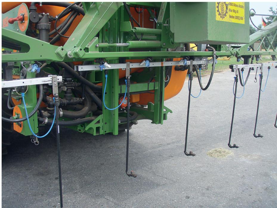
Abb. 4: Lechler-Dropleg am Spritzleitungsverband des Super-S-Gestänges.
