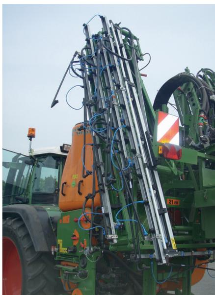
Abb. 3: Lechler-Dropleg im eingeklappten Zustand.
