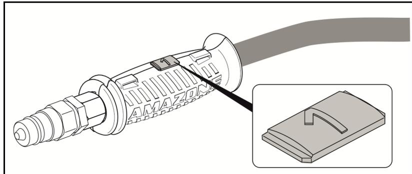
Zu den Markierungen sind Folien an die Maschine geklebt, die die entsprechenden Hydraulikfunktionen verdeutlichen.
