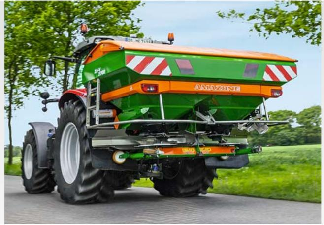
SafetySet – der umlaufende Schutzbügel erfüllt die Unfallverhütungsvorschriften. Großflächige Warntafeln sowie die Beleuchtungsanlage sorgen für mehr Erkennbarkeit im Straßenverkehr.
