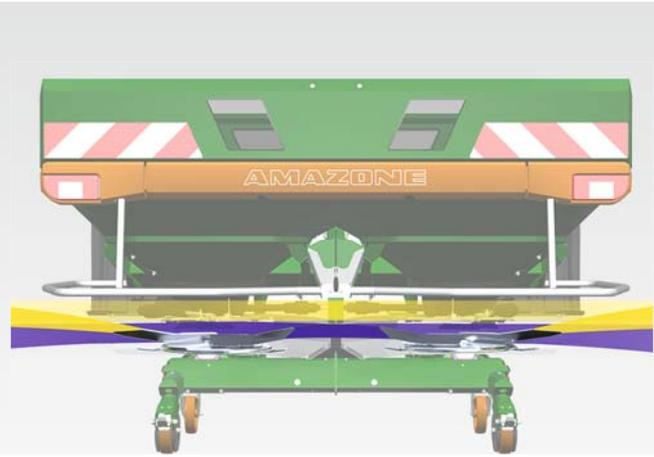
Multistreifächer – besonders gute Querverteilung, da der Streufächer der langen Schaufel über den der kurzen Schaufel fliegt.
