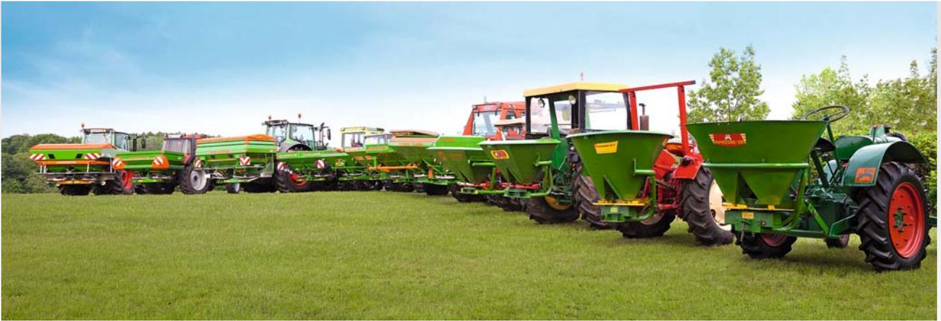
Das konstruktive Grundprinzip des ersten ZA ist über alle weiteren Baureihen bis heute erhalten geblieben: Der Doppeltrichter und die zwei gegenläufig, aber mit konstanter Drehzahl angetriebenen Streuscheiben.
