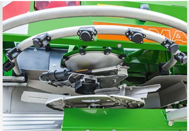
Entwicklungsprojekt System Argus – Radarsensor-System 2013
