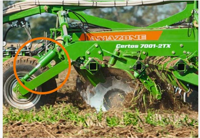
Stufenlose, hydraulische Einstellung der Arbeitstiefe
