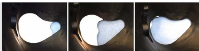
Auslauföffnung mit automatischer Korrektur des Mengeneffekts
