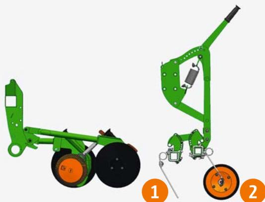
Rollenstriegel: ① Schleppzinkenstriegel und ② Rollenbalken bei der AD-P Special im Einsatz
