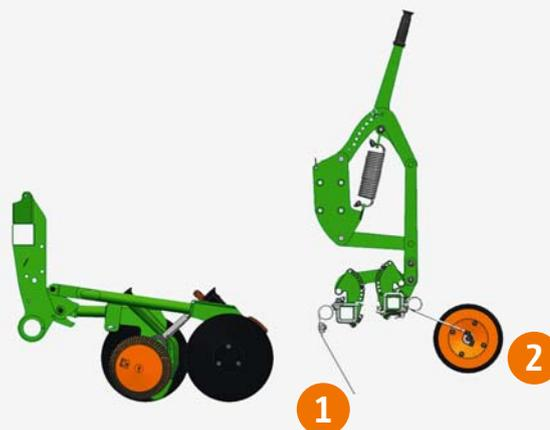
Rollenstriegel in Nullposition: ② Rollenbalken bei der AD-P Special außer Kraft gesetzt – ① Schleppzinkenstriegel weiter im Einsatz
