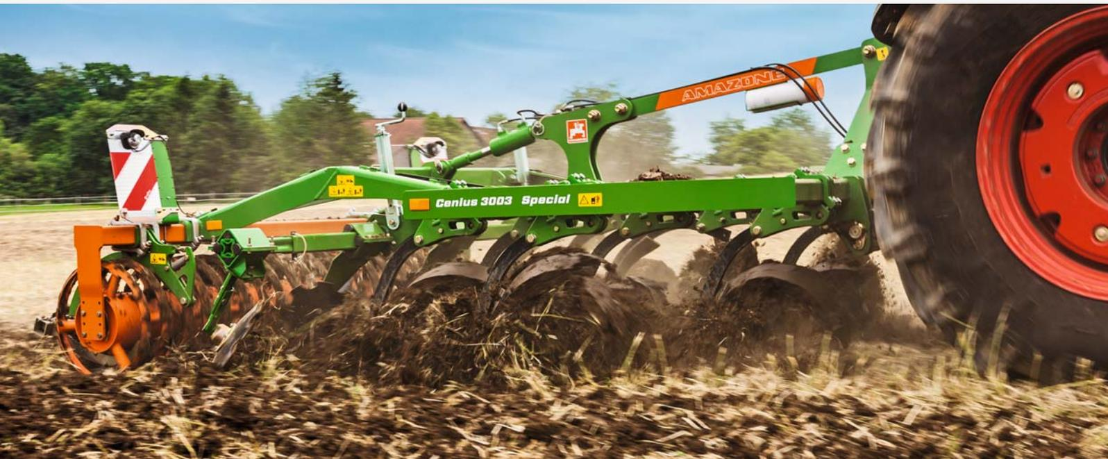
Mit dem neuen C-Mix-Scharsystem bietet AMAZONE für die Grubbertechnik ein umfangreiches Angebot. Für die flache Bodenbearbeitung wird das C-Mix-Gänsefußschar oder das C-Mix-Flügelschar, für die mitteltiefe Bearbeitung die C-Mix-Spitze 100 mit dem Leitblech 100 und für die tiefere Bearbeitung die C-Mix-Spitze 80 und das Leitblech 80 angeboten.
