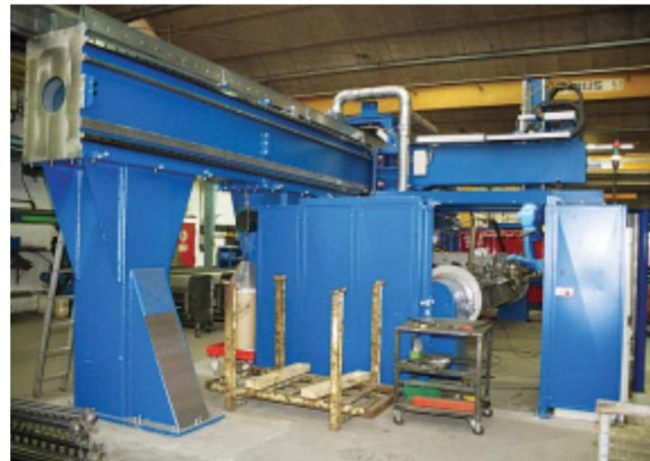
Portalroboter zum Schweißen von Sämaschinen-Rahmen
