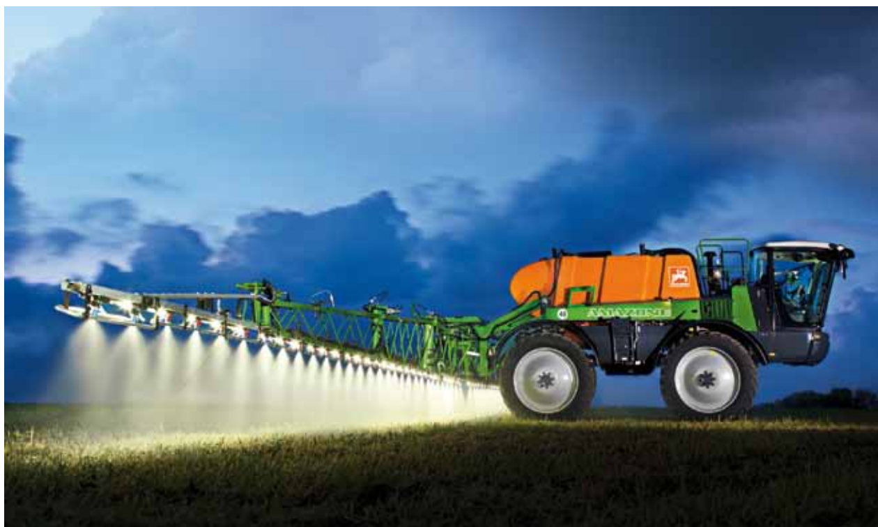
■ Abb. 7: Pantera im Nachteinsatz. Eine Beleuchtungsanlage am Gestänge oder eine LED-Einzeldüsenbeleuchtung wie hier am Selbstfahrer Pantera, erleichtern die Arbeit bei Dämmerung und Dunkelheit.
