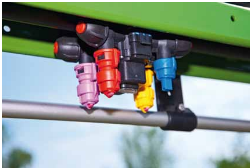
■ Abb. 6: Mit Vierfach-Düsenkörpern eröffnet die elektrische Einzeldüsen-schaltung AmaSelect viele neue Möglichkeiten der teilflächenspezifischen Applikation.
