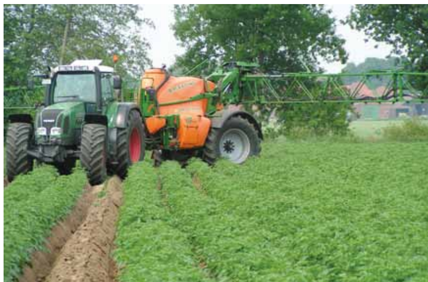
■ Abb. 2: Die spurtreue Achsschenkelenkung belastet das Gestänge im Gegensatz zur Deichselenkung nicht. Die Steuerung erfolgt nur auf die Räder und muss auch in der Fahrgasse nicht abgeschaltet werden, der Rahmen und damit die Aufhängung des Gestänges liegen ruhig.
