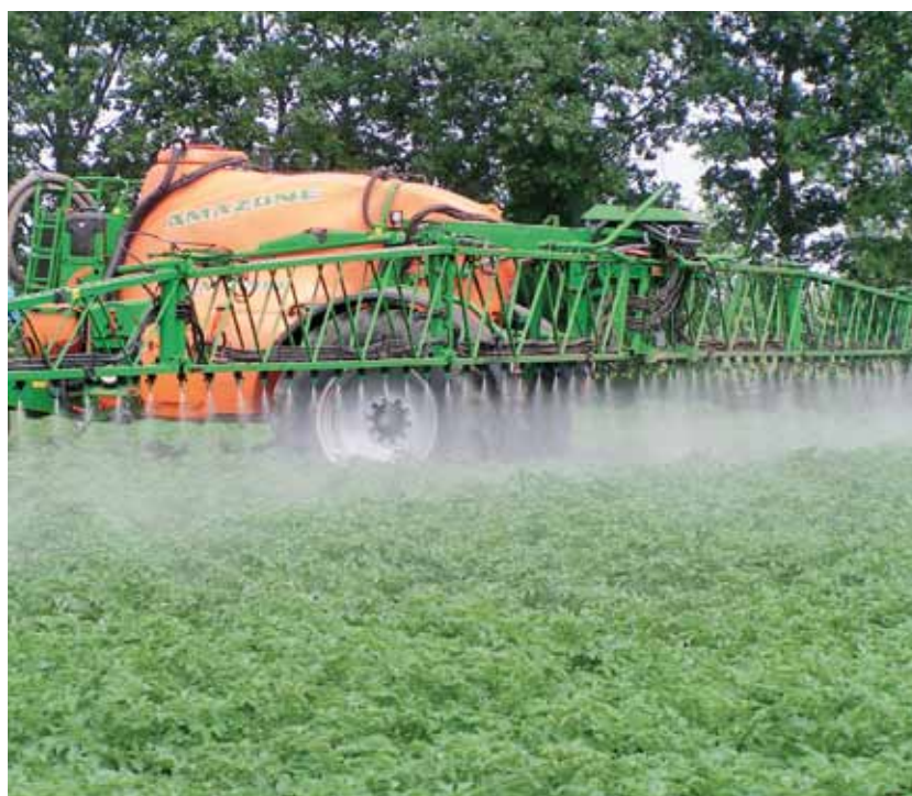
■ Abb. 5: Die Gestänge sollten möglichst leicht, aber dennoch absolut stabil gebaut und mit einer Mehrfachdämpfung ausgerüstet sein. Das ist im Kartoffelanbau besonders wichtig, weil häufig Dämme überfahren werden müssen.
