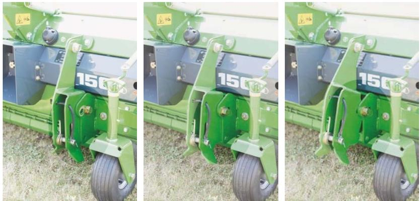
**Der Durchmesser der Unterlenkerbolzen entspricht KAT I.**
