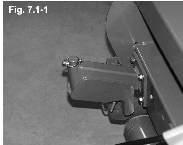
Zur Höheneinstellung, ist die Maschine anzuheben, Splint und Bolzen an beiden Seiten zu entfernen und die Walze in der gewünschten Position abzustecken und der Bolzen mit dem Splint zu sichern. (Fig. 7.1-2).
