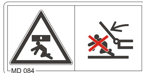
**MD 086****Gefährdung durch Quetschen für den gesamten Körper, verursacht durch den notwendigen Aufenthalt unter angehobenen, ungesicherten Teilen der Maschine!**
