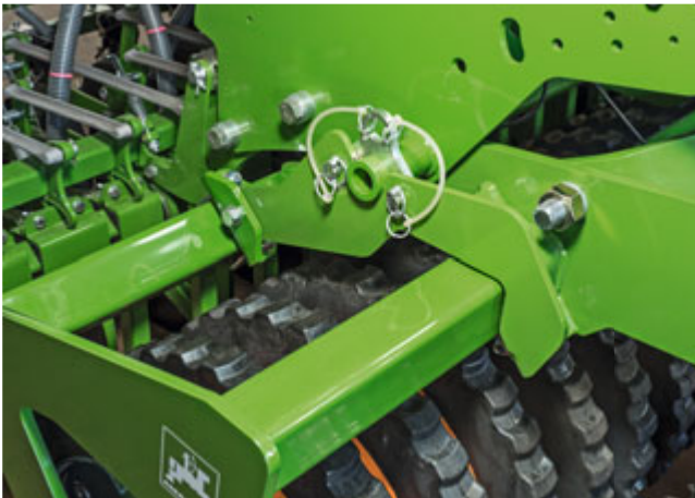
✔ Schnellkuppelsystem QuickLink – Einfacher, schneller und werkzeugloser An- und Abkuppelvorgang
