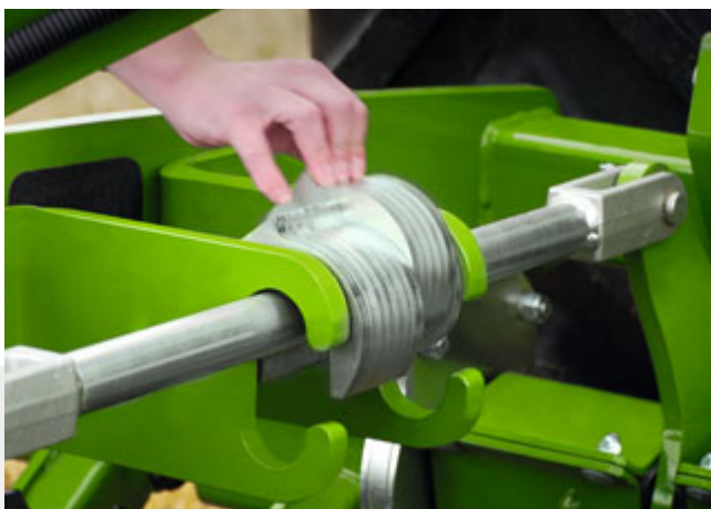
Arbeitstiefeneinstellung durch Distanzelemente – hier flache Arbeitstiefe
