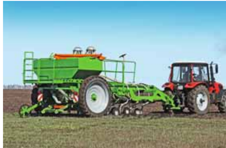
Verfahren 1: Pneumatische Sämaschine 3 m mit ConTeC-Scharen am Belarus MTS 1221.4 (120 PS).
