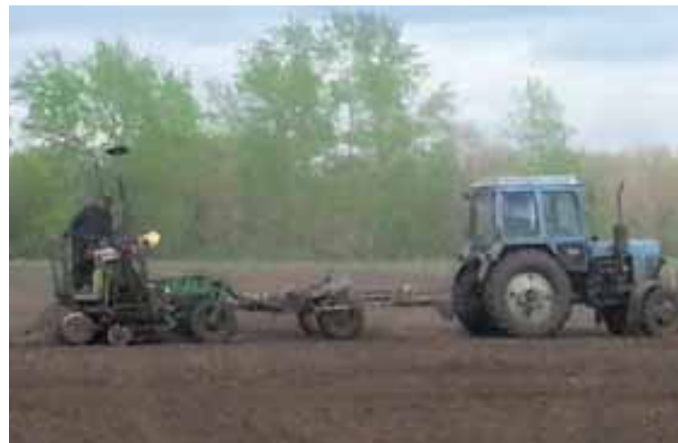
Verfahren 2: Mechanische Scheibendrille C3П mit 7,2 m Arbeitsbreite am Belarus MTS 50 (50 PS).
