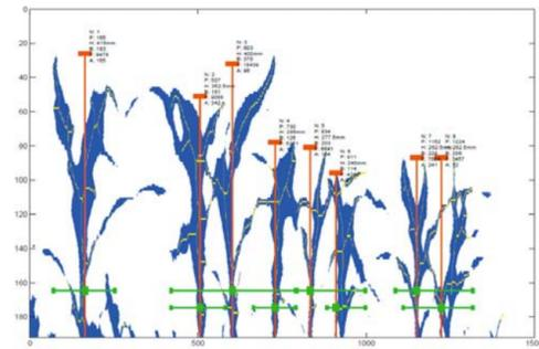
Diese App besteht aus einem speziellen hochauflösenden bildgebendem Lichtgitter, einem Triangulationssensor und einer Digital-kamera. Die Daten dieser Sensoren können zur Interpretation von morphologischen Pflanzeigenschaften genutzt werden. Die Abbildung „Lichtgitter Messdaten“ stellt die Daten des Lichtgitters als Schattenbilder der Pflanzen dar.
