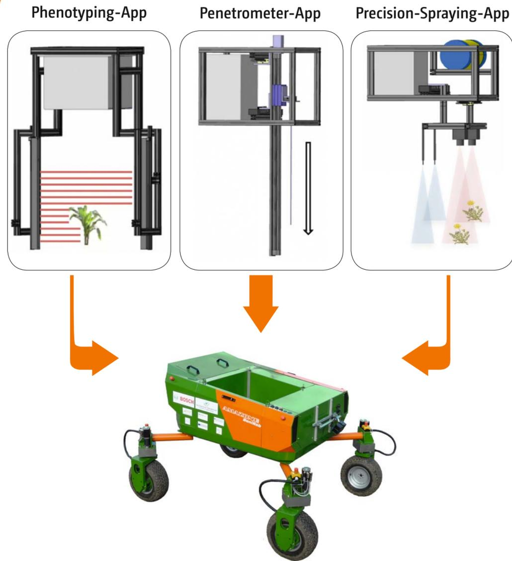
Die Nutzung des BoniRob als vielseitige Feldroboterplattform – also als Träger- und Versorgungssystem für verschiedene Apps – ist mit der klassischen Verbindung eines Traktors mit verschiedenen Anbaugeräten vergleichbar. Die gezeigten BoniRob-Apps
