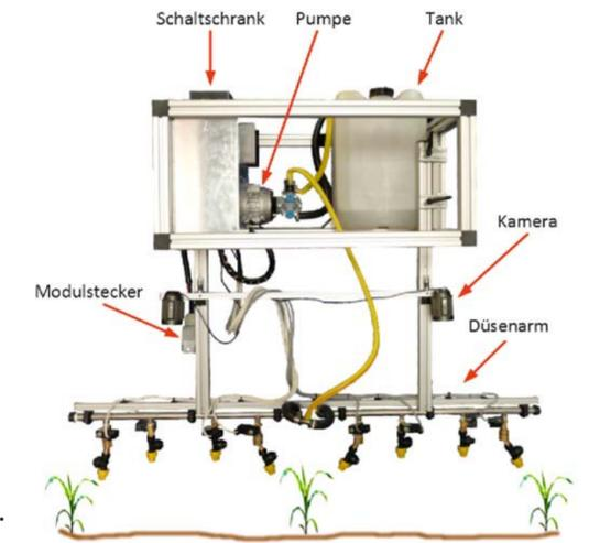
Diese App ist ein kamerabasiertes Applikationsmodul zur selektiven Unkrautregulierung. Durch das gezielte Ausbringen von Herbiziden ergeben sich sowohl ökologische wie ökonomische Vorteile. Die nachfolgende Abbildung zeigt den Aufbau des Applikationsmoduls. Alle 75 cm ist eine Kamera angebracht, die im Zusammenspiel mit einer
