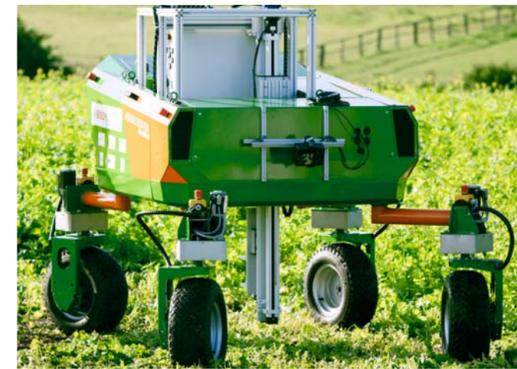
Diese App integriert einen mechanischen Aktuator in BoniRob. Hierbei kann ein Penetrometer Bodeneigenschaften bis zu einer Tiefe von 80 cm messen. Außerdem ist ein Feuchtigkeits- und ein Temperatursensor implementiert. Die Daten der einzelnen Messpunkte werden durch elektrische Antriebe automatisch aufgenommen und ge-
