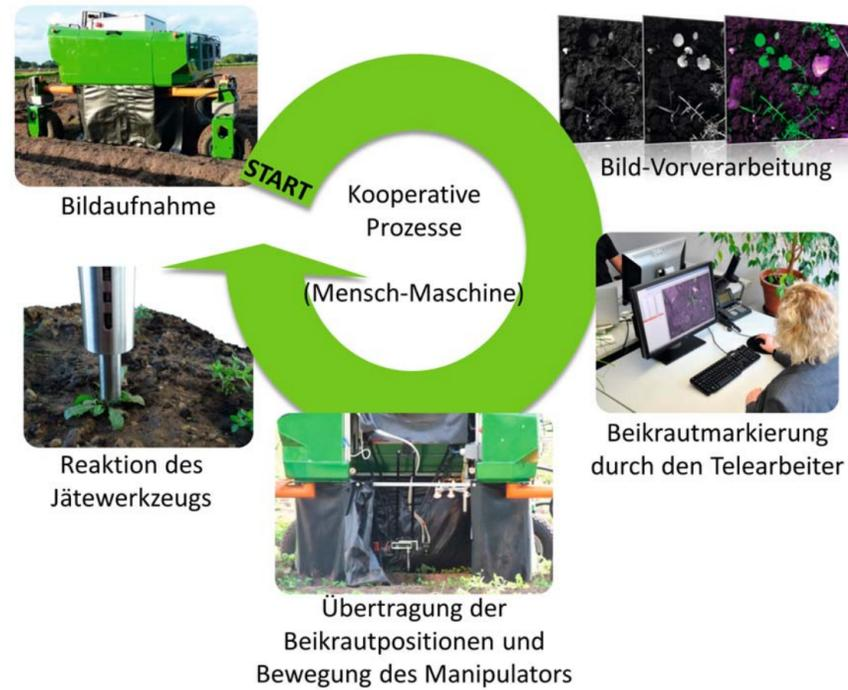
Im Rahmen des Forschungsprojektes RemoteFarming.1 werden ein BoniRob und eine App zur mechanischen Beikrautregulierung realisiert. RemoteFarming.1 geht jedoch über die Umsetzung einer speziellen Anwendung für einen Feldroboter hinaus. Es beinhaltet die Integration von BoniRob und App als Teil eines komplexeren Umfelds, welches webbasierte Kommunikation, Server, Webclient und einen Menschen am Telearbeitsplatz umfasst. Das System verfügt über einen mechanischen Beikrautaktor.
