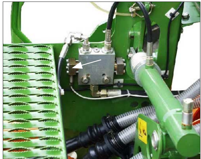
Sämaschine mit zwei Spuranreißer-Sensoren
