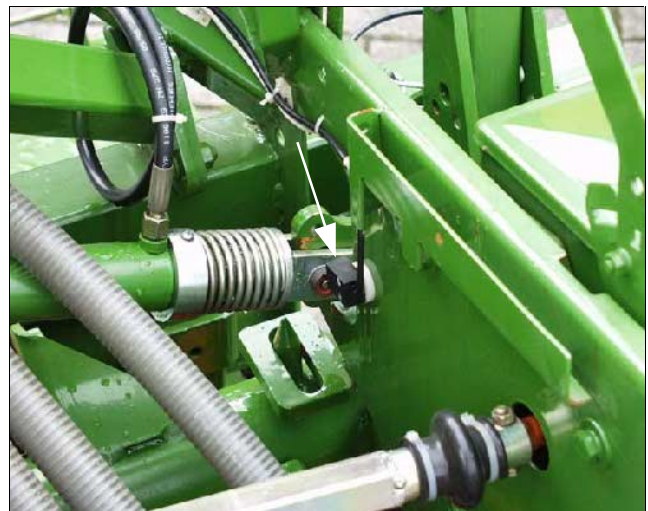
Sämaschine mit zwei Spuranreißer-Sensoren
