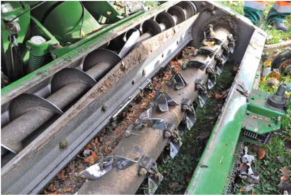
An der Rotorwelle der Mäheinheit sind 72 Schlegelmesser montiert. Diese lassen sich werkzeuglos tauschen – sehr gut. Das Mähgut wird von den Messern in die Querschnecke befördert und in die Mitte zur Längschnecke geführt. Von dort geht es in den Sammelbehälter.
